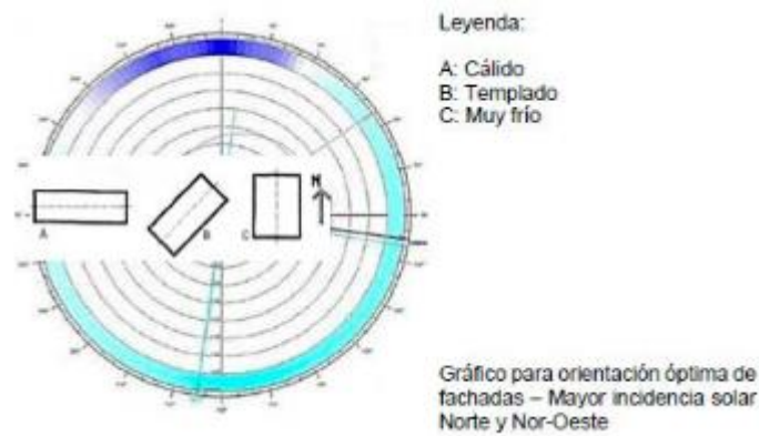
Figura 2. Orientación de una vivienda. Hemisferio sur para diferentes climas Fuente: Mori Acuña, 2018. (p. 5)
