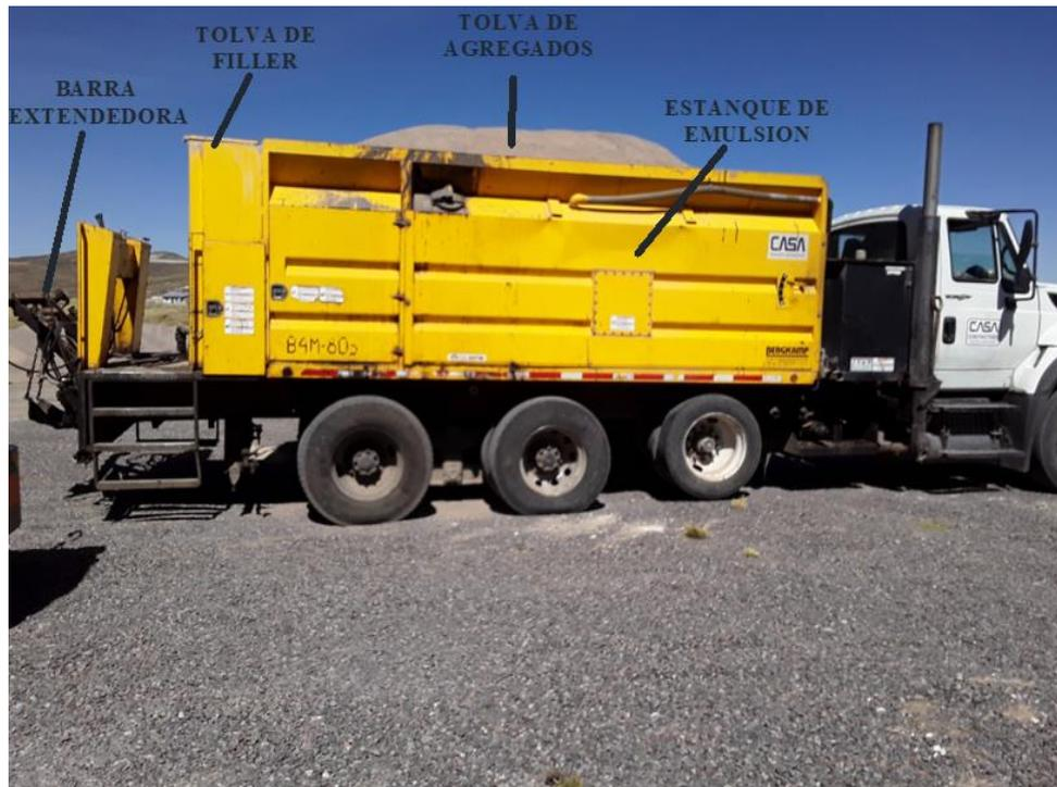
**Figura 2.7:** Equipo de aplicación del slurry seal
