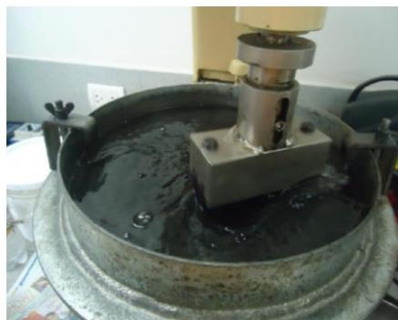
**Figura 3.21:** *Equipo para el ensayo de abrasión en húmedo*
