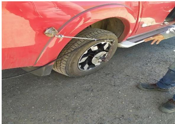
**Figura 3.46:** *Odómetro acoplado al neumático del vehículo.*
