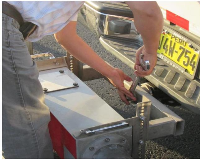
**Figura 3.48:** *Instalación del perfilómetro láser en la parte de atrás.*
