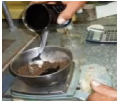
**Figura 3.19:** *Ensayo de tiempo de mezclado, slurry seal tipo II*
