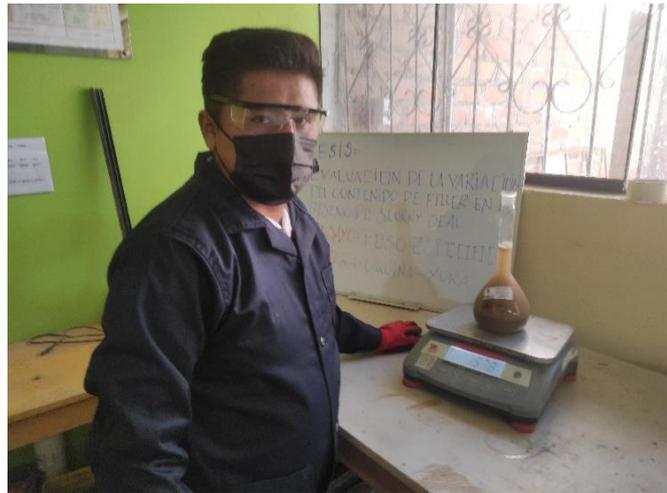
*Figura 3.7: Realización del ensayo de peso específico*
