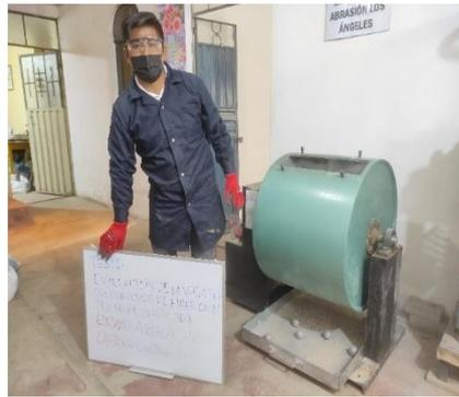
**Figura 3.9:** Realización del ensayo de abrasión
