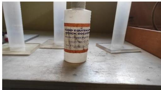
**Figura 3.4:** Sustancia química  $CaCl_2$ , para el ensayo de equivalente de arena
