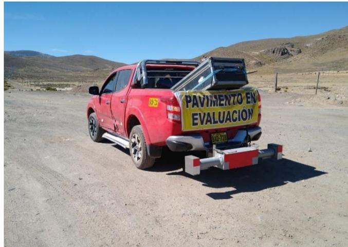
**Figura 3.45:** Perfilómetro láser RSP – MARK IV
