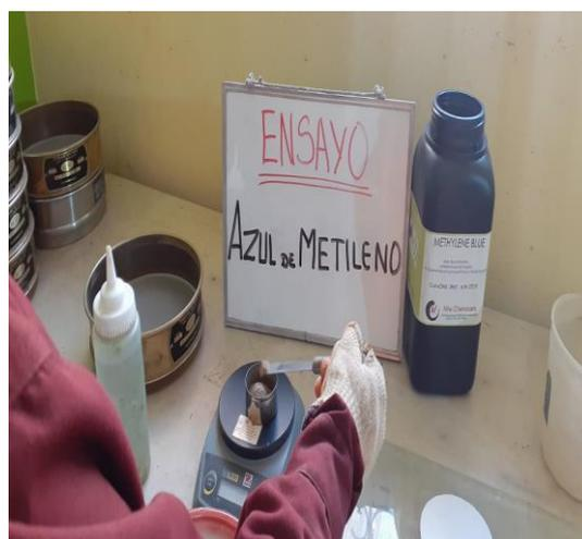
**Figura 3.12:** *Material fino ensayado*
