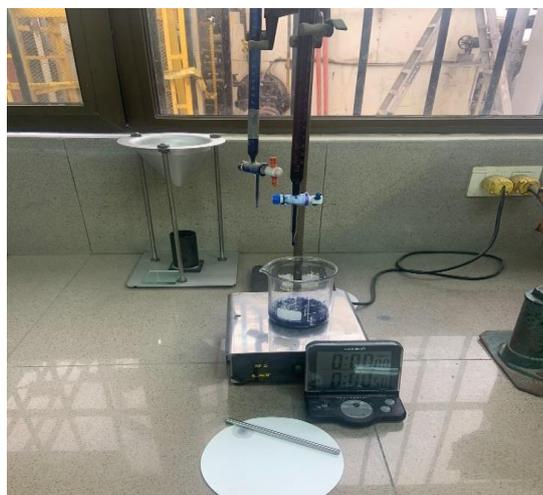
**Figura 3.11:** *Realización del ensayo azul de metileno*
