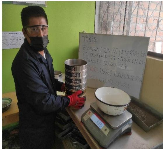
**Figura 3.3:** Realización del ensayo de análisis granulométrico
