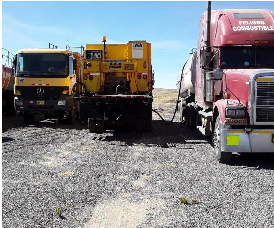
**Figura 3.42:** *Succión de emulsión, Cisterna de emulsión – micropavimentador*
