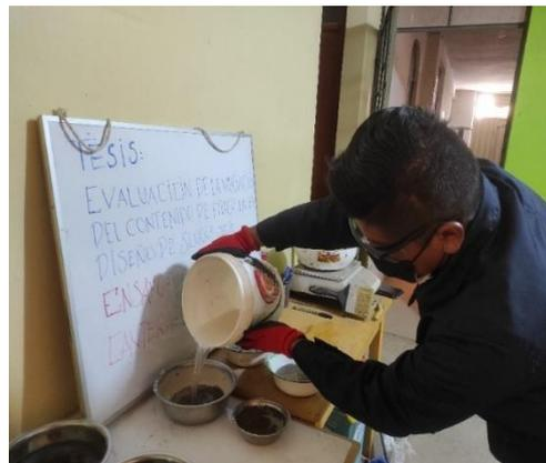
**Figura 3.10:** Realización del ensayo durabilidad a los sulfatos de los agregados
