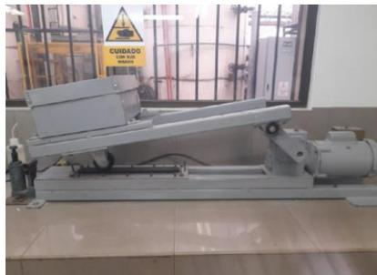
**Figura 3.25:** *Equipo para el ensayo de rueda cargada*
