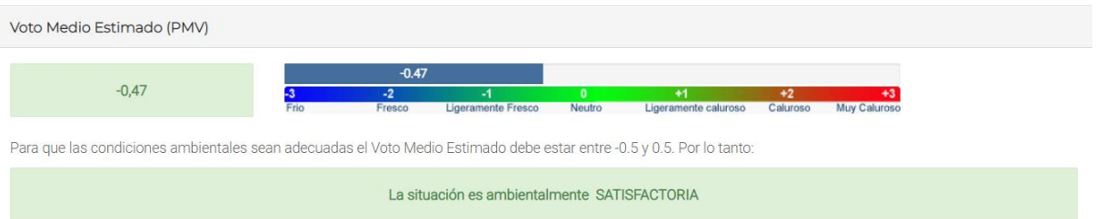
Figura 47: Simulación del PMV obtenido con valores mínimos para lograr confort térmico .
