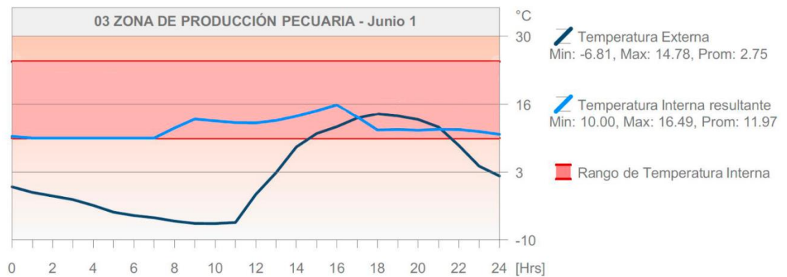
Figura 120: Simulación de temperatura interna en la zona de producción pecuaria- Temporada de invierno.
