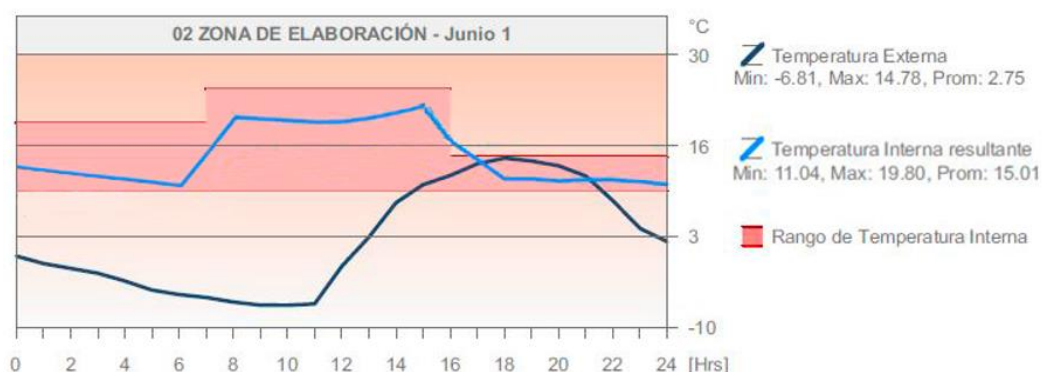
Figura 118: Simulación de temperatura interna en la zona de elaboración-Temporada de invierno.
