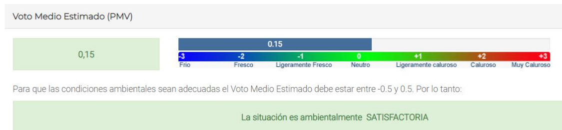
Figura 70: Simulación de PMV con datos obtenidos de la propuesta de diseño.
