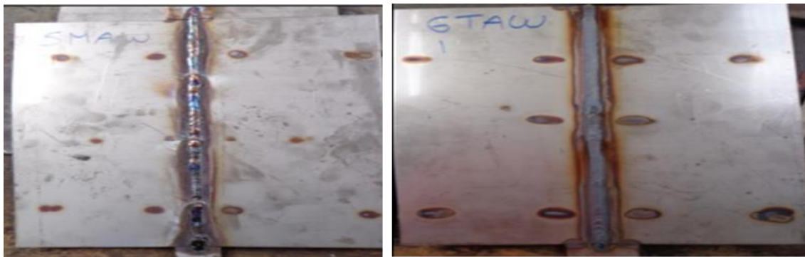
Figura 14. Juntas soldadas con proceso SMAW y GTAW
