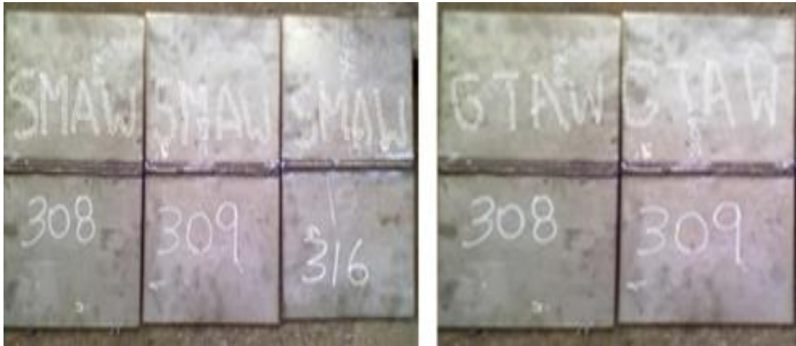
Figura 13. Preparación de placas del proceso de soldadura SMAW y GTAW
