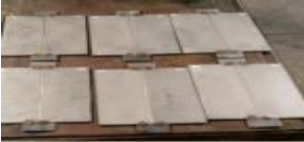
Figura 11. Probetas de acero AISI 304 en distintas posiciones
