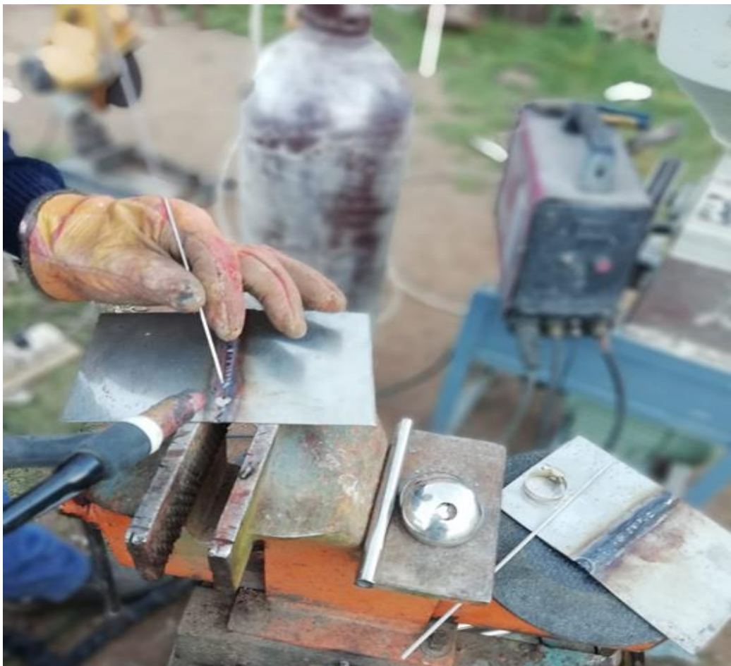
Figura 12. Elaboración de probetas con proceso GTAW
