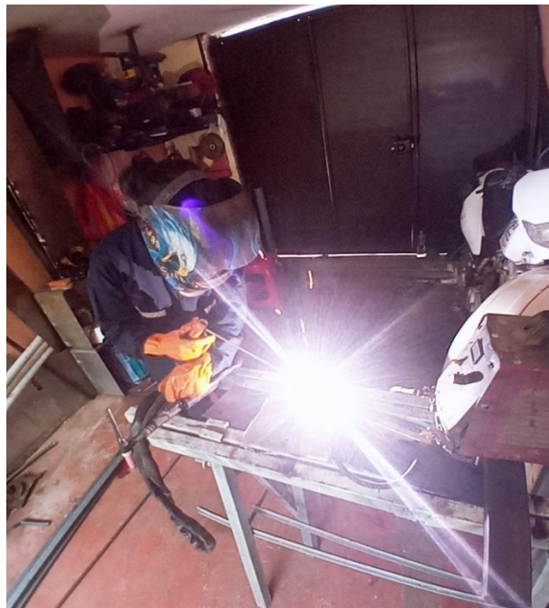
PROCESO DE SOLDADURA SMAW
