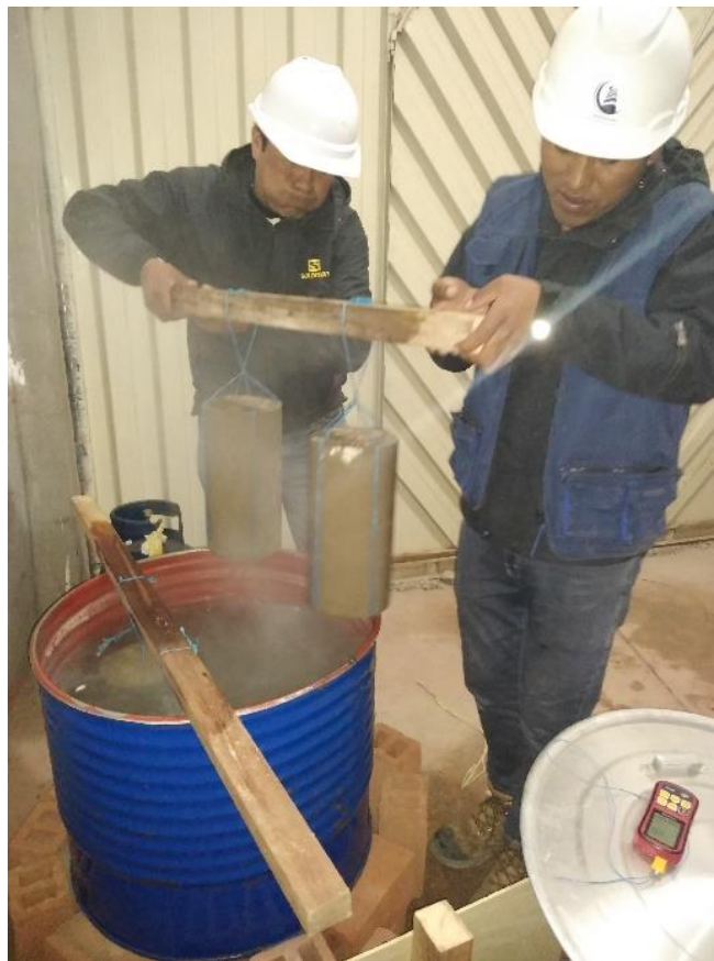
D16. Retiro de las muestras del tanque de curado acelerado.
