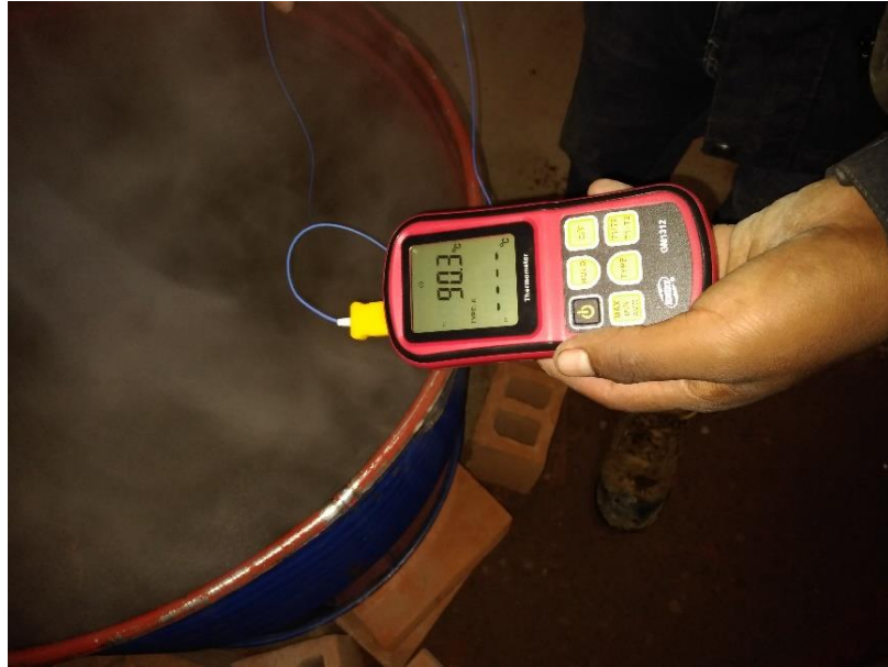
D11. Control de temperatura del agua para realizar el curado acelerado.
