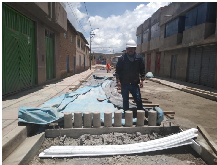
Figura 6. Curado de especímenes bajo las condiciones de obra. Fuente: Elaborado por el equipo de trabajo.
