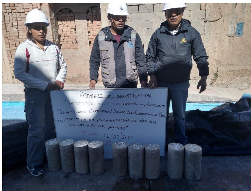
D4. Desencofrado de las muestras de concreto para el curado en obra.
