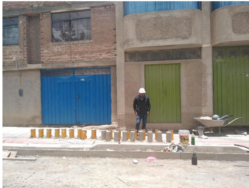
D5. Desencofrado de las muestras de concreto para el curado en obra y curado estándar del segundo punto.
