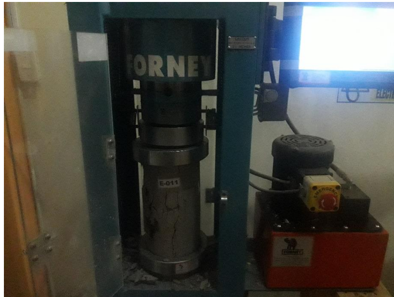
D 18. Rotura de muestras de concreto.
