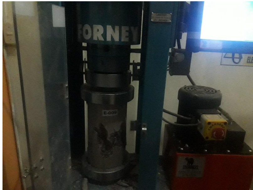
D19. Rotura de muestras de concreto.
