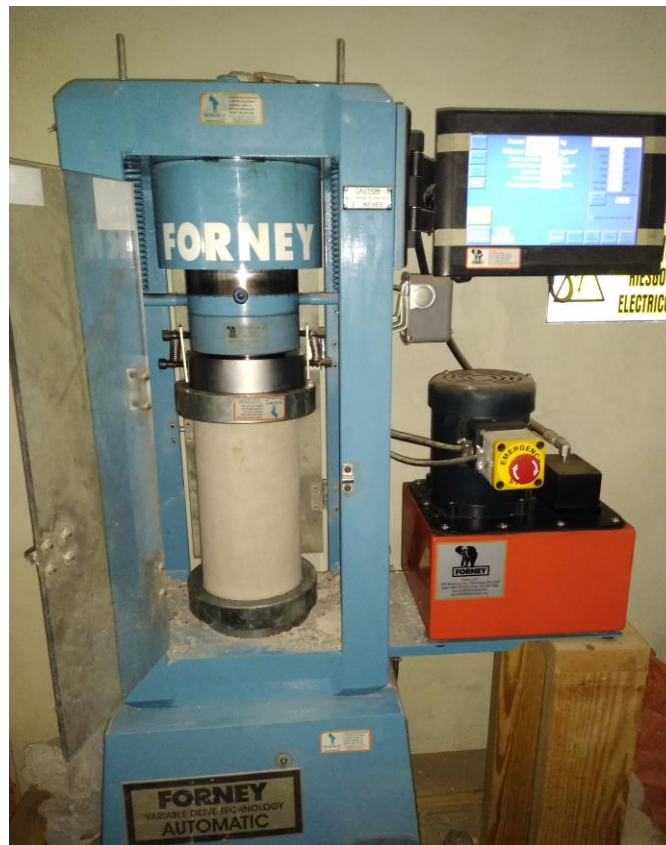
Figura 2. Ensayo a la compresión simple del concreto. Fuente: Elaborado por el equipo de trabajo.
