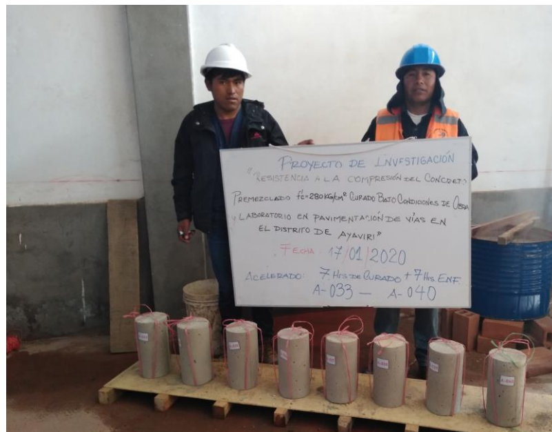
Figura 8. Curado acelerado de especímenes. Fuente: Elaborado por el equipo de trabajo.
