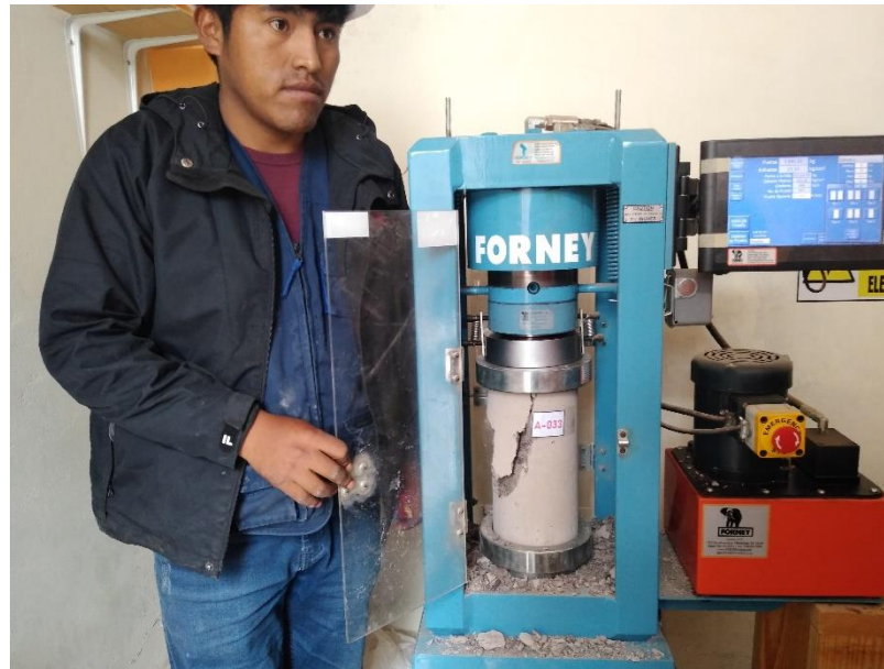
D21. Rotura de muestras de concreto.
