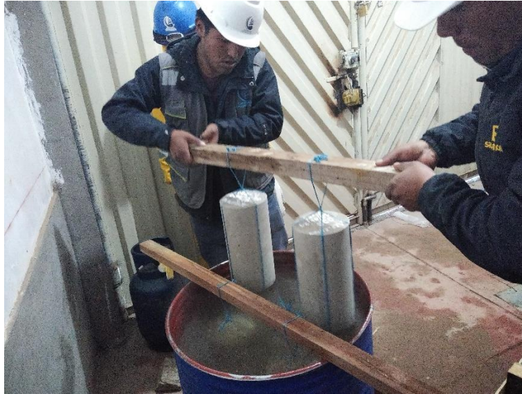
D15. Colocación de muestra al tanque de curado acelerado.
