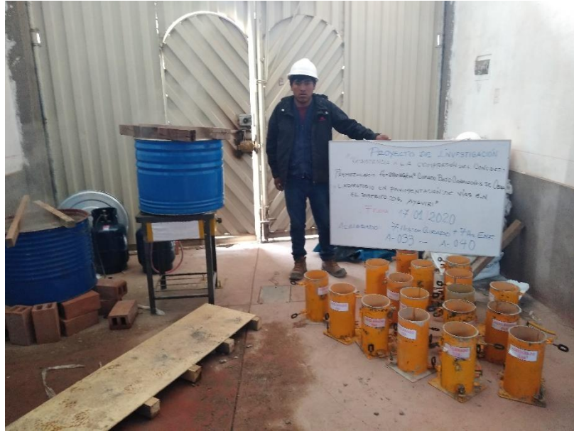
D13. Desencofrado de muestras de concreto para curado acelerado.
