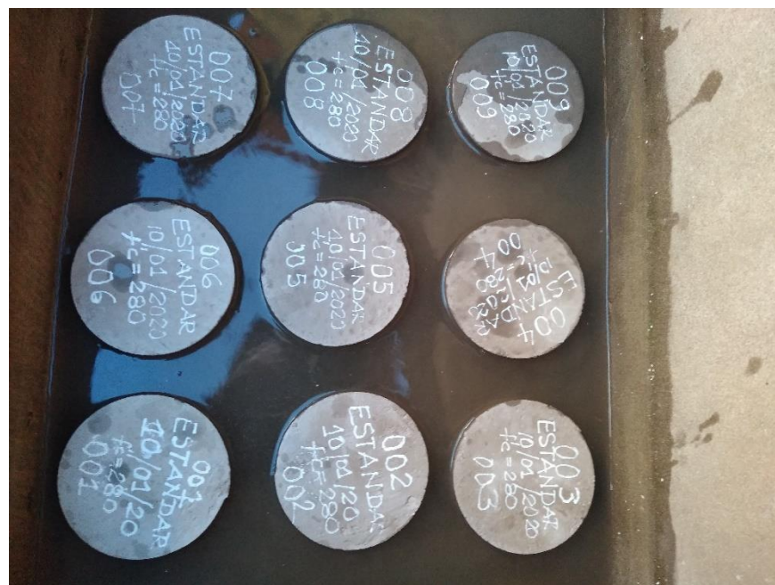
Figura 7. Curado de especímenes en las condiciones de laboratorio.
