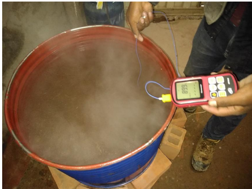
D12. Control de temperatura del agua para realizar el curado acelerado.
