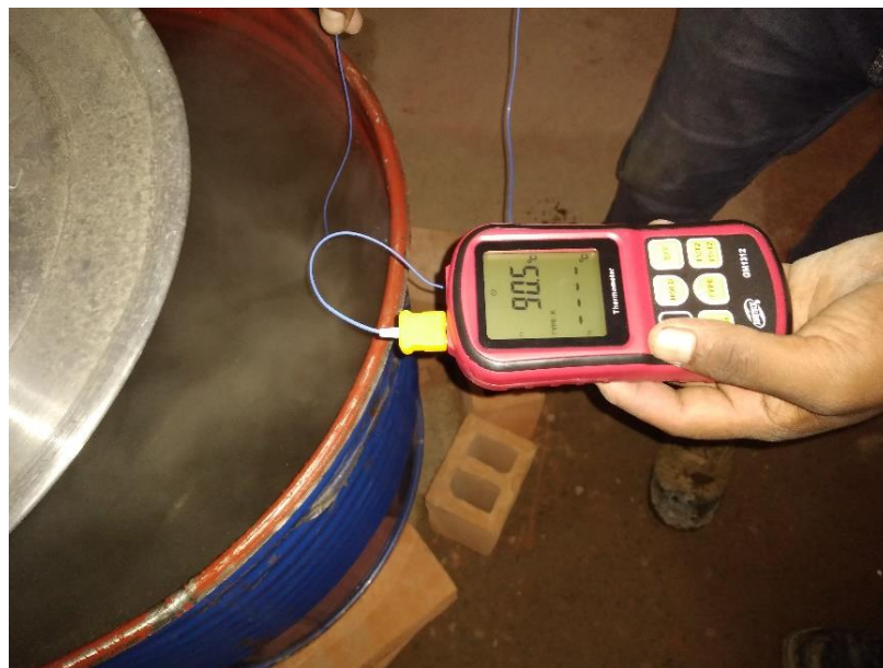
D10. Control de temperatura del agua para realizar el curado acelerado.
