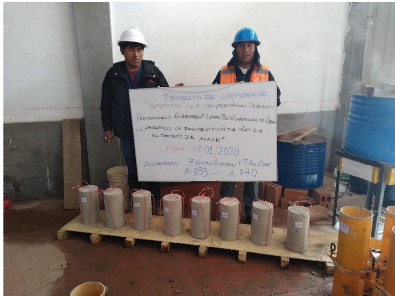
D14. Colocación de rafias a las muestras de concreto para poder mantener los bordes libres.
