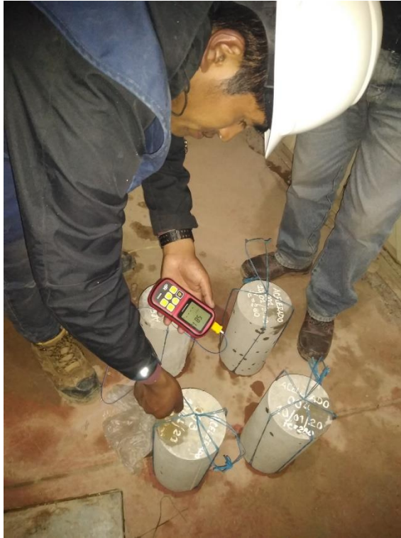
D17. Retiro de las muestras y control de temperatura de las muestras.
