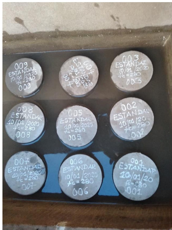
D2. Colocación de las muestras de concreto en la poza de curado estándar
