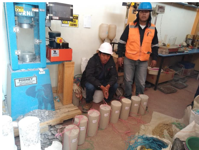
D20. Rotura de muestras de concreto.
