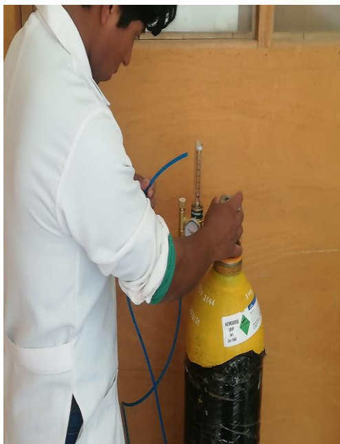
Figura 11. Apertura de la llave de la válvula del tanque de Nitrógeno UHT (99.999 N).
