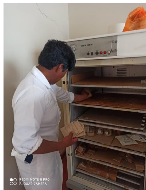
Figura 20. Introduciendo las muestras a la estufa a 60 °C por 24 horas.
