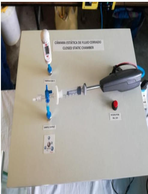
Figura 15. Colocación del colector (sensor) por donde pasa la muestra de (CH 4 ), conexión del ventilador y termómetro.
