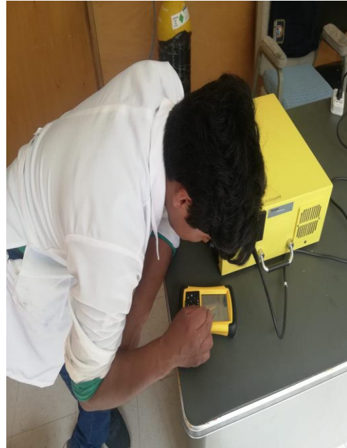
Figura 14. Analizador portátil de gases Gaset DX 4030. Visualización de los datos de calibración del PDA.
