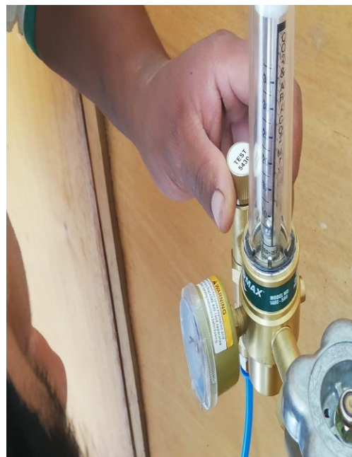
Figura 12. Apertura de la perilla reguladora, fijándose que el manómetro ejerza una presión en cilindro de 5L.
