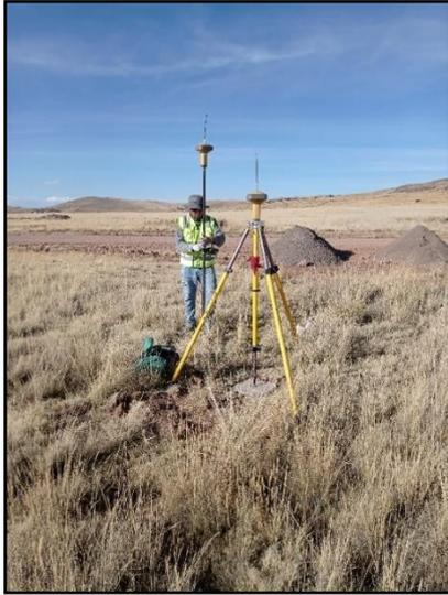
*Nota:* En la figura se muestra el levantamiento de los puntos de fotocontrol.
