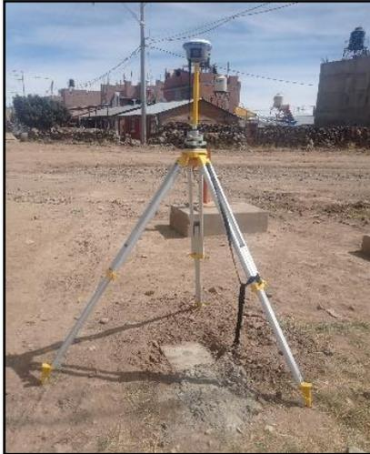
*Nota:* Posicionamiento del receptor GNSS en el punto geodesico.
