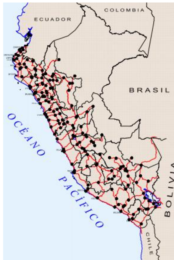
Figura 6. Red de nivelación de alta precisión (NAP) realizada por el IGN Fuente: (IGN, Norma Técnica Geodésica, 2016).
