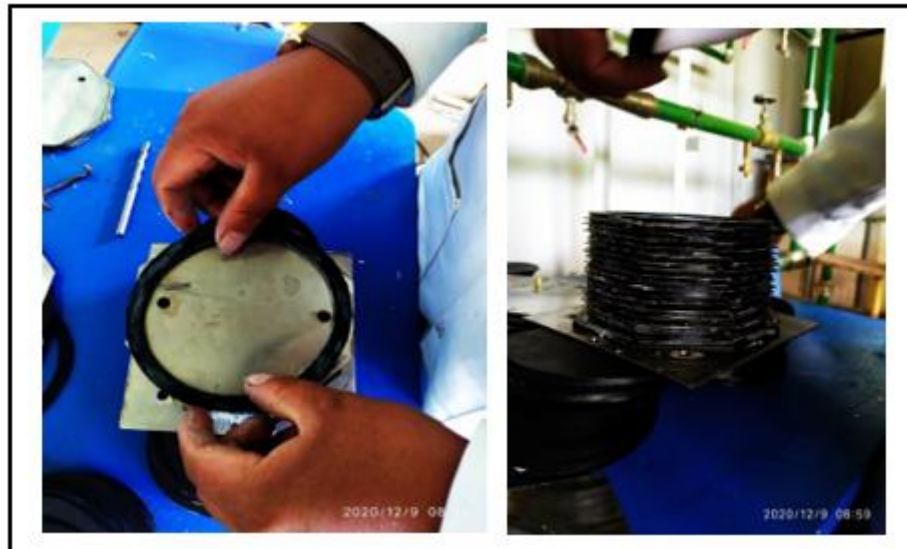
Figura 22. Colocación de juntas
