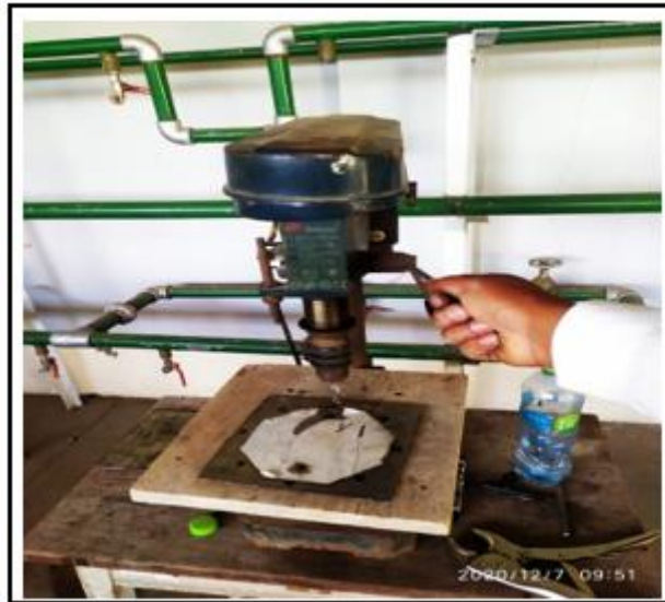
Figura 16. Recorte y perforación de placas en forma octogonal
