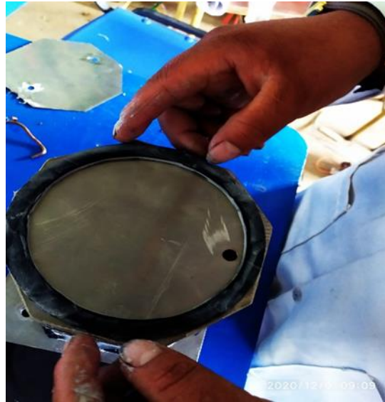
Figura 25. Electrodo separador de gases y el vacío entre celdas
