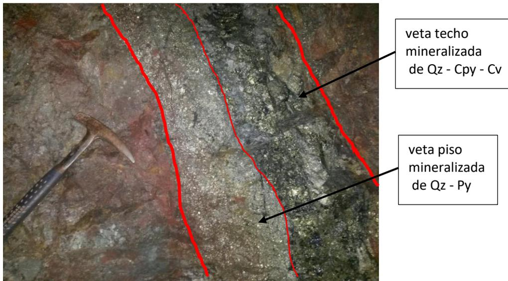
**Figura 21.** Fotografía de la veta Gisela, Nivel 1930 (Tajeo 998 Este) mirando al Este, potencia 0.60m., con contenido calcopirita, covelina, pirita, cuarzo, roca caja con pátinas de OxFe (hematita), alteración silicificación. (Fuente: Elaboración propia).
