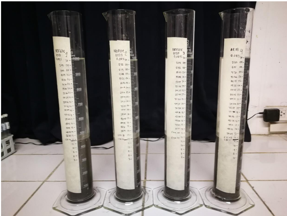
Figura 11. Altura de sedimentación de relaves.
