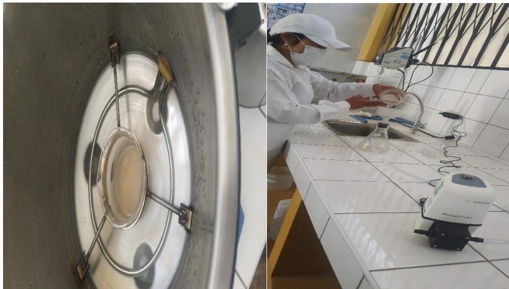
Fotografía N°6: filtración rápida bomba al vacío, volumen de lixiviado de mineral de litio.
