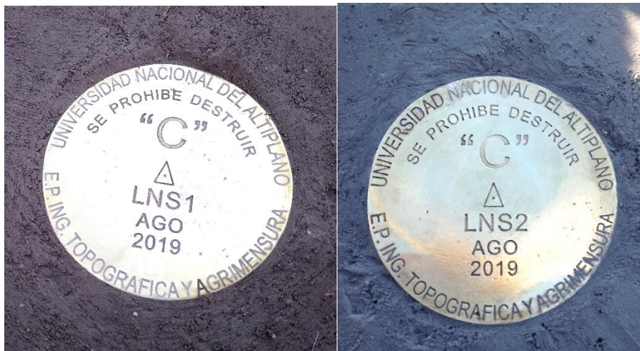
Figura 7: Monumentación de los puntos geodésicos en la Presa Lagunillas.
