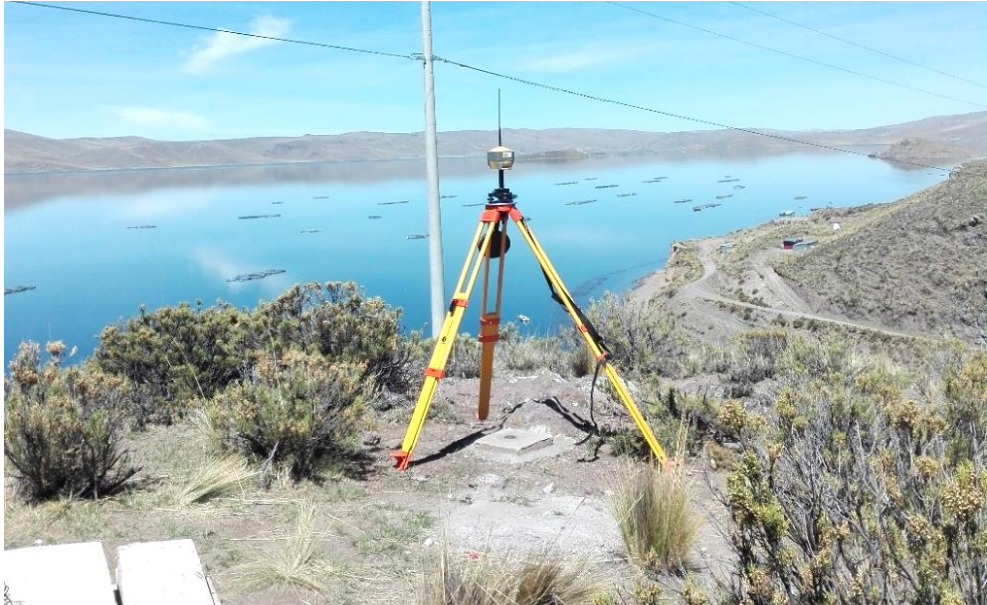
Figura 24: Estación base en el punto geodésico LNS1.
