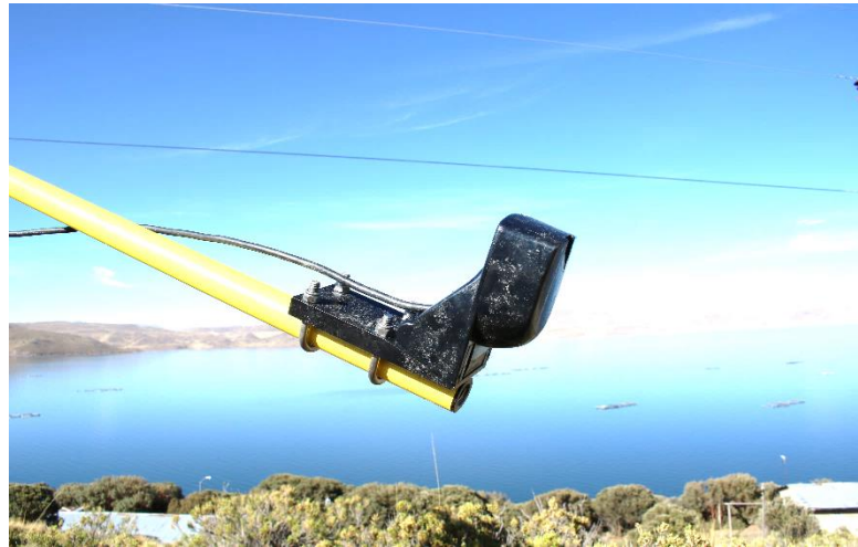
Figura 19: Transductor del ecosonda Hidrolite empleado en la batimetría. Fuente: Elaboración Propia
