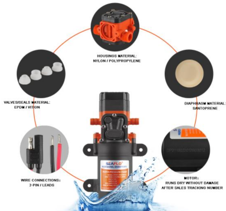
Figura N°51: Detalles de la electrobomba.
