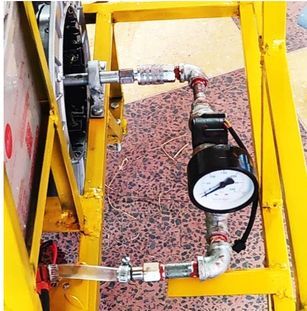
Figura N°52: Accesorios hidráulicos (agua).
