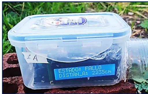
Figura N°115: Pantalla de visor de datos de sensor ultrasónico y el estado de conexión inalámbrica.
