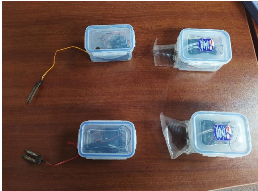
Figura N°138: Sensores de humedad y sensores Ultrasónicos.
