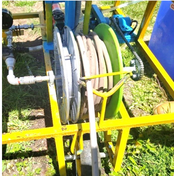
Figura N°133: Montaje de carretes de manguera y cable de acero.
