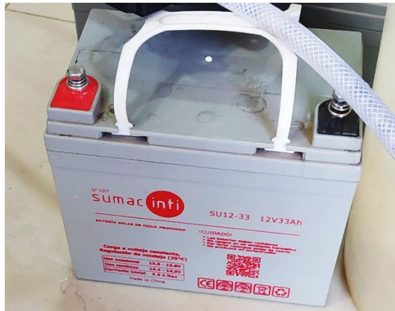
Figura N°69: Batería para panel solar.
