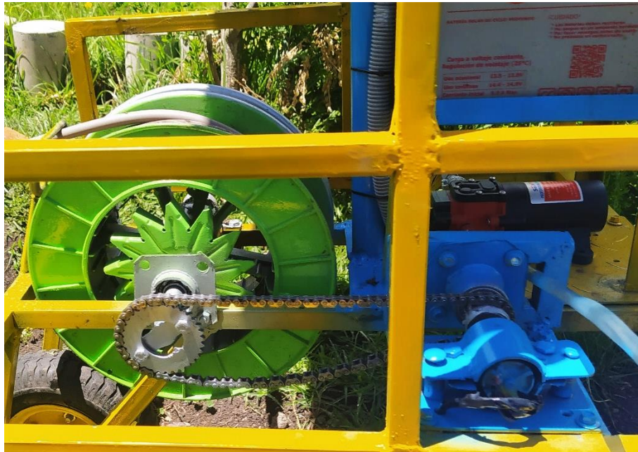
Figura N°132: Montaje del sistema de transmisión mecánica.
