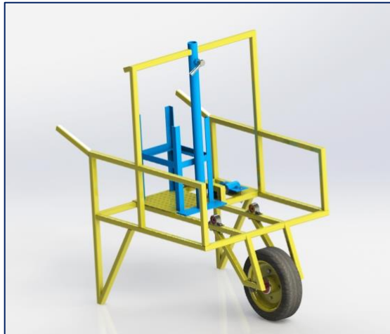
Figura N°99: Modelamiento 3D de carreta impulsora.
