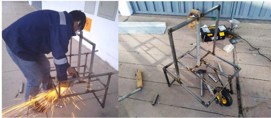
Figura N°44: Construcción de carrete.
