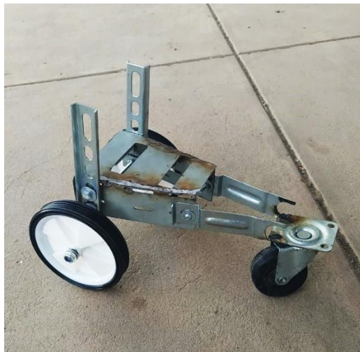
Figura N°48: Proceso de construcción de la carreta de descarga.
