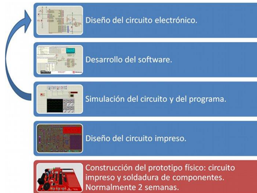
Figura N°74: Ciclo de proceso de construcción de circuito electrónico definido.
