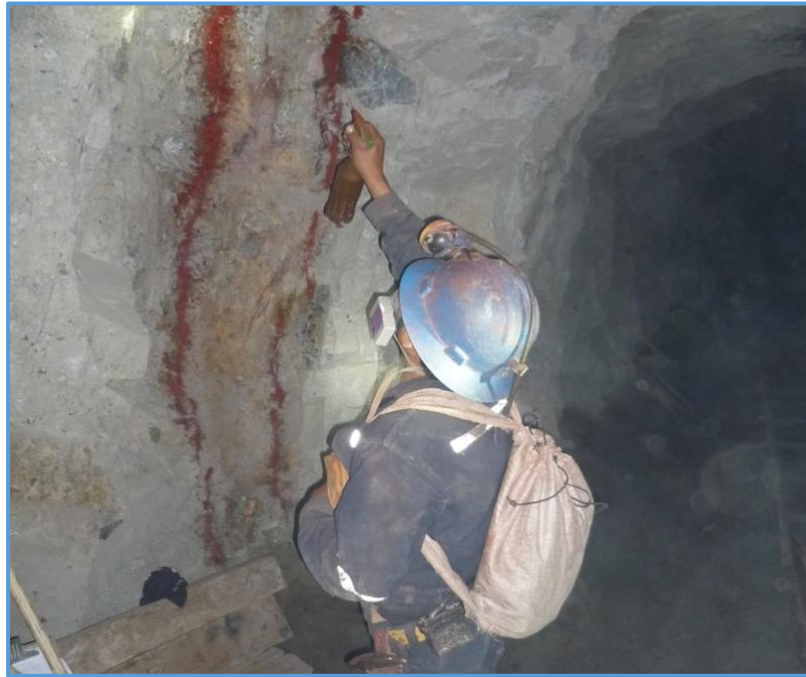
Figura 15: Marcado de estructuras
