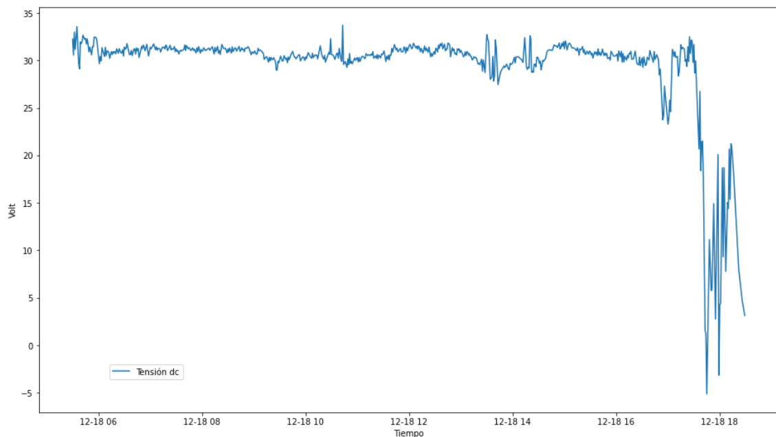
Figura 46. Tensión en corriente continua medida en la entrada del microinversor
