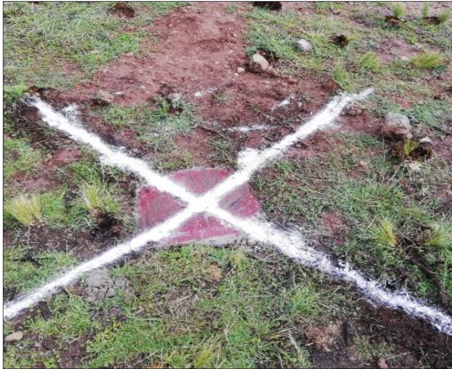
Figura 41. Punto geodésico listo para el vuelo fotogramétrico Fuente: (Elaboración propia)
