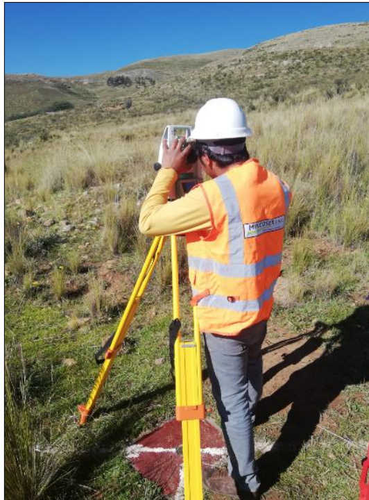
Figura 43. Levantamiento topográfico con estación total de los puntos de comparación estratégicos (PCE) Fuente: (Elaboración propia)
