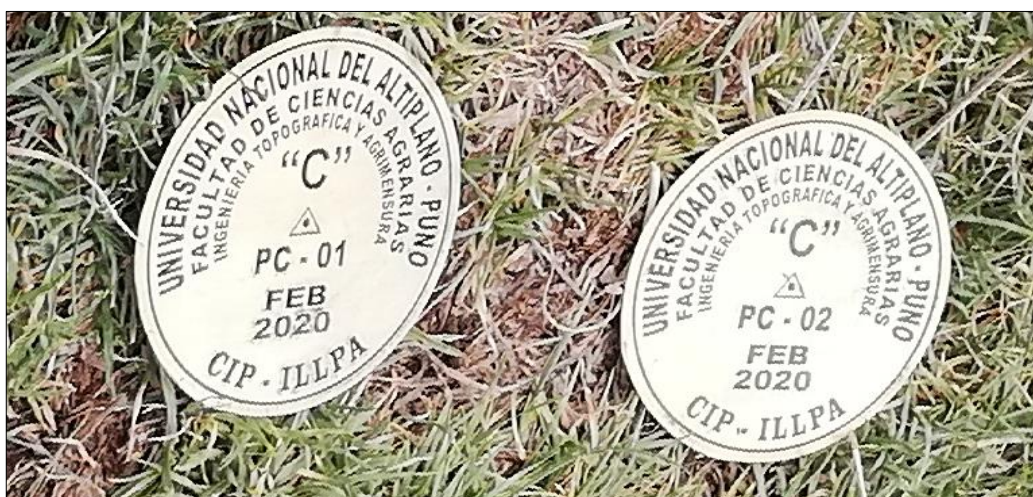
Figura 35. Placas geodesicas para los puntos de control geodesicos Fuente: (Elaboracion propia)
