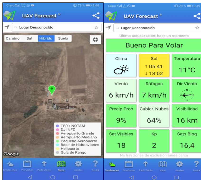
Figura 46. Verificación de las condiciones climatológicas para la realización de los vuelos con ayuda de la App UAV Forecast Fuente: (Elaboración propia)
