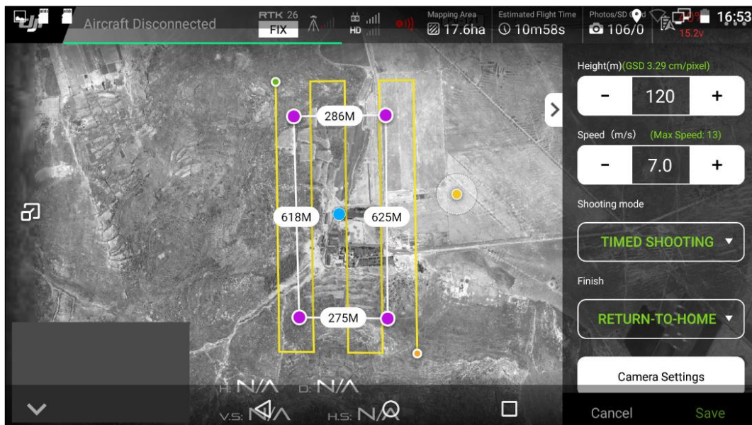
Figura 52. Planificación del vuelo 3 con una altura de vuelo de 120 m Fuente: (Elaboración propia)
