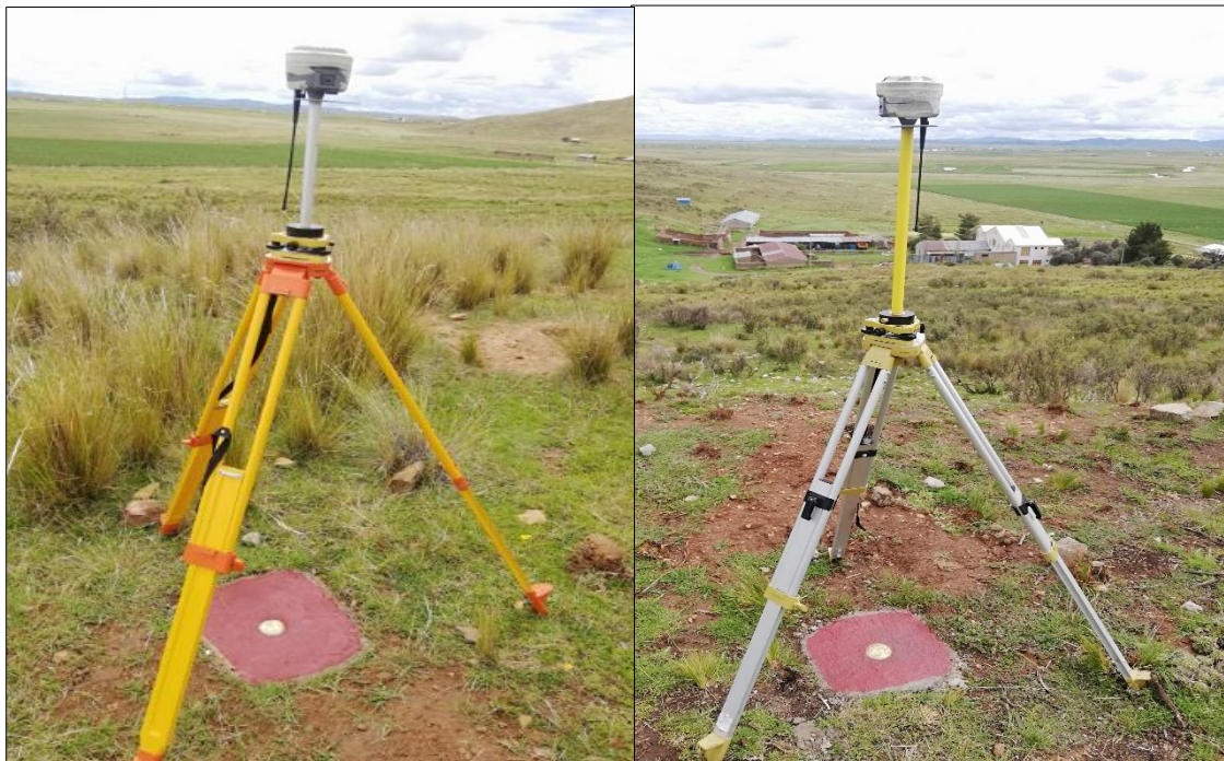
Figura 38. Posicionamiento y registro de datos de los puntos PC- 01 y PC- 02 con ayuda del receptor GNSS. Fuente: (Elaboración propia)
