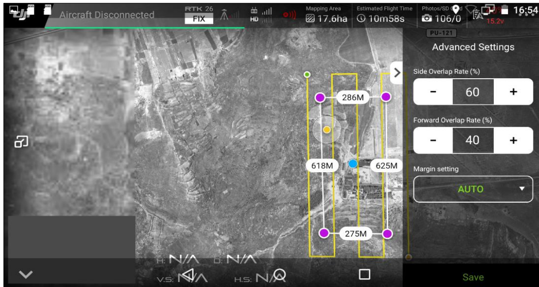
Figura 51. Planificación del vuelo 3 con un traslape de 40% longitudinal y 60% transversal Fuente: (Elaboración propia)
