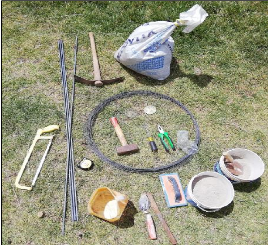
Figura 34. Insumos necesarios para la monumentación de puntos geodésicos Fuente: (Elaboración propia)
