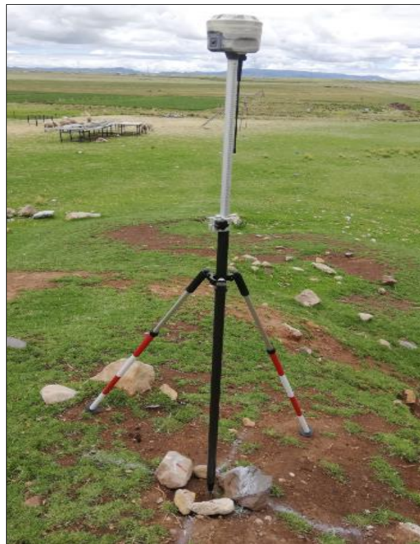
Figura 40. Replanteo de los 15 GCP con ayuda del receptor GNSS en modo RTK Fuente: (Elaboración propia)
