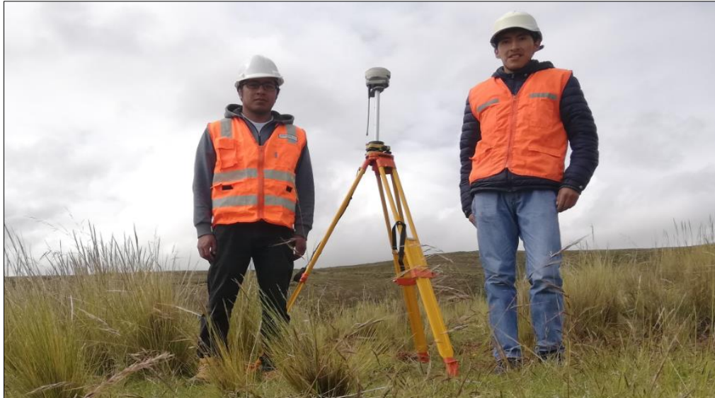
Figura 39. Ajuste de línea base entre el PC-01 y el PC-02 Fuente: (Elaboración propia)
