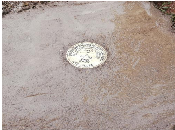
Figura 37. Monumentación de uno de nuestros puntos de control geodésico Fuente: (Elaboración: propia)
