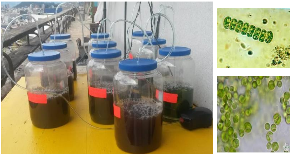
Figura 7. Esquema del tratamiento in vitro de la capacidad de biorremediación de materia orgánica con el consorcio microalgal Scenedesmus sp y Chlorella sp.
