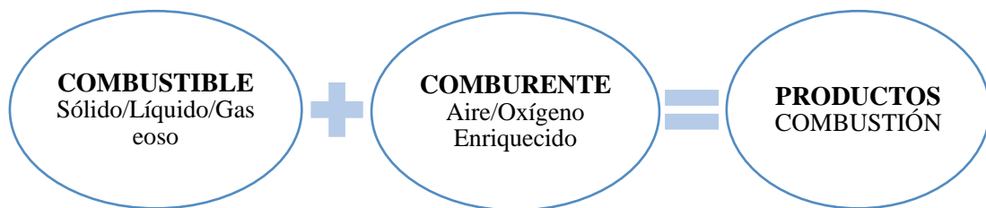
Figura N° 4: Esquema del proceso de combustión.
