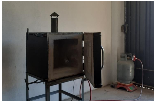
Figura N° 30: (prototipo de horno a gas instalado)
