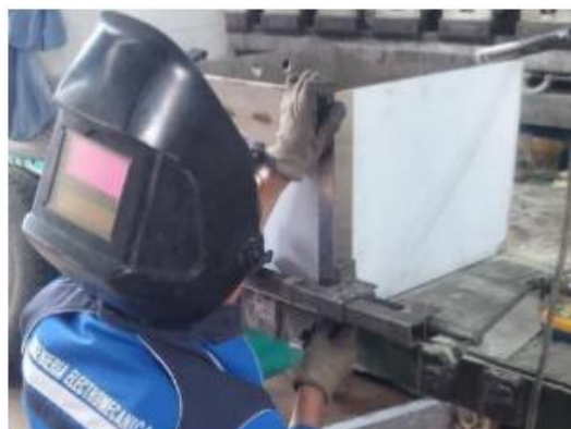
Figura N° 24: Sujeción y soldado del recubrimiento del horno
