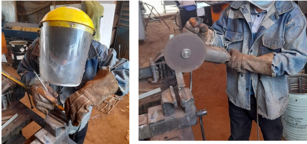
Figura N° 20: medición y Corte del acero angular con amoladora eléctrica
