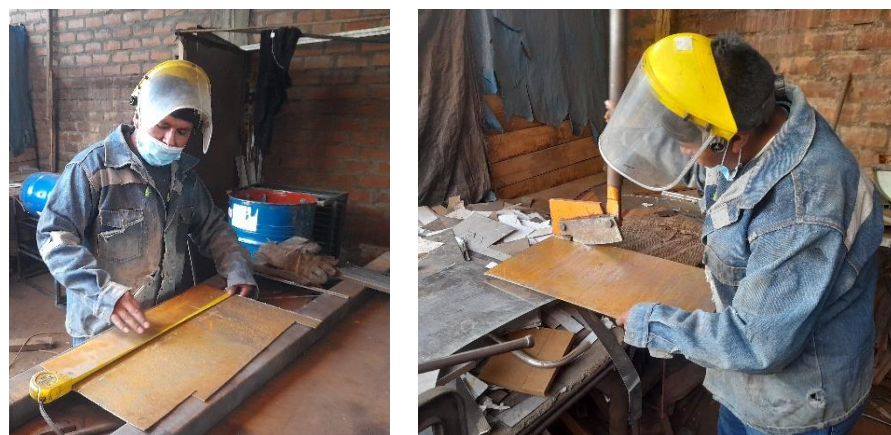
Figura N° 22: Corte y perforación de la plancha de acero
