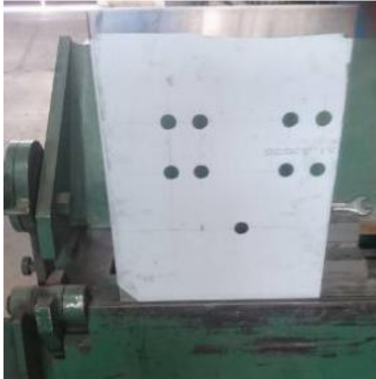
Figura N° 23: Doblado de las aristas de la plancha
