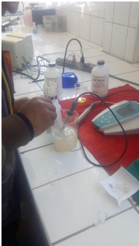
B 2. Ajuste de pH y lixiviación por agitación.
