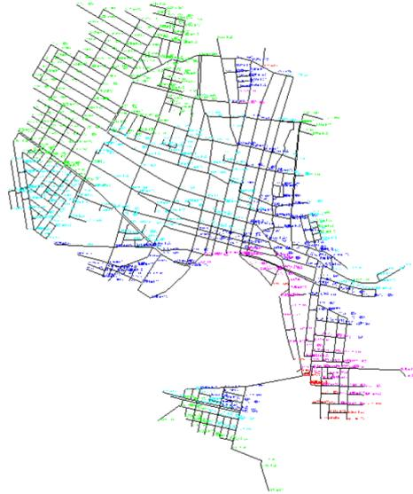
La ilustración anterior representa en colores el rango de presiones en metros de columna de agua en cada unión (Junction) presentando en la siguiente tabla donde las presiones entre 0 – 5 m.c.a. representado por el color verde, las presiones entre 5 – 10 m.c.a. representado por el color celeste, las presiones entre 10 – 15 m.c.a. representado por el color azul, las presiones entre 15 – 20 m.c.a. representado por el color rosado y las presiones entre 20 – 25 representado por el color rojo.
