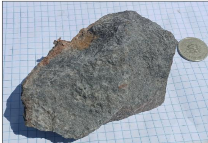
Figura 7 Muestra de Roca Superficial. Nota: muestra de roca andesitas tomadas en el estribo izquierdo con coordenadas N: 8406404.71 y E: 616375.99.
