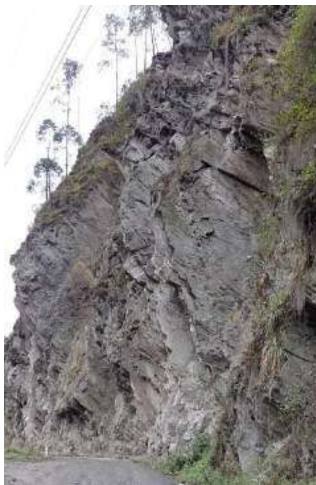
FOTO 02: Estación geomecánica 01 con dirección NS, afloramientos de roca filita de la Formación Sandía, se muestra un pendiente bastante agreste.
