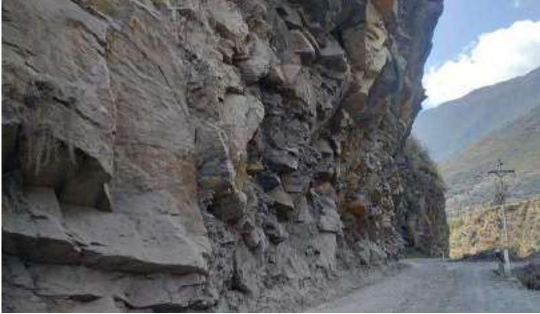
FOTO 03: Estación geomecánica 02 con dirección NS, afloramientos de roca metarenisca de la Formación Sandia.
