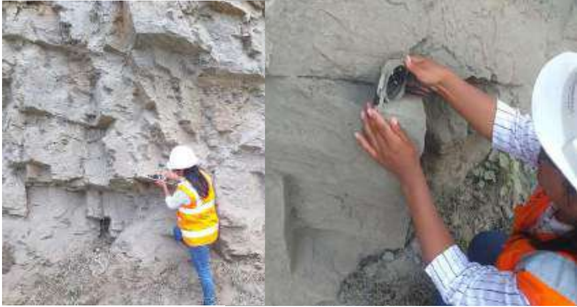
FOTO 07: Toma de actitudes buzamiento y dirección de buzamiento de las discontinuidades existentes.
