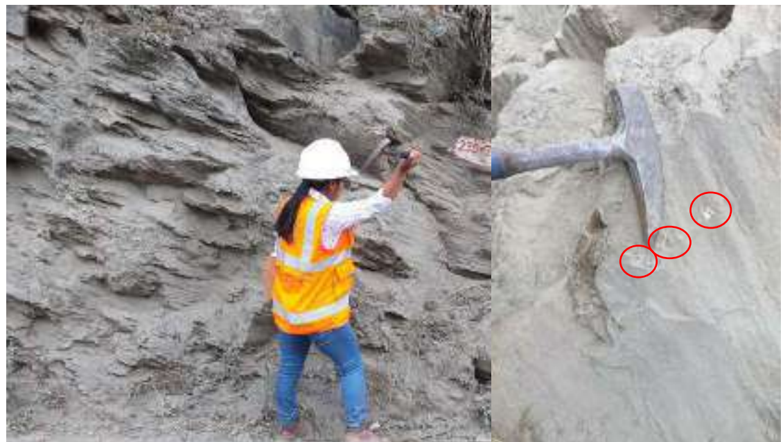
FOTO 08: Medición de la resistencia a la compresión simple con martillo de geólogo.
