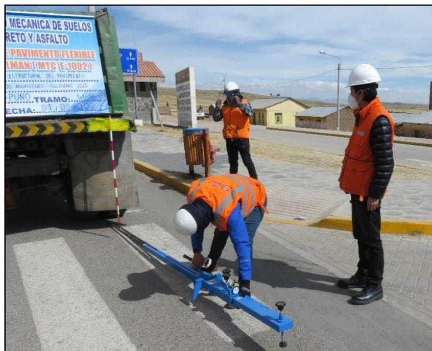
**Figura 24:** Colocación de la Viga sobre el punto de ensayo
