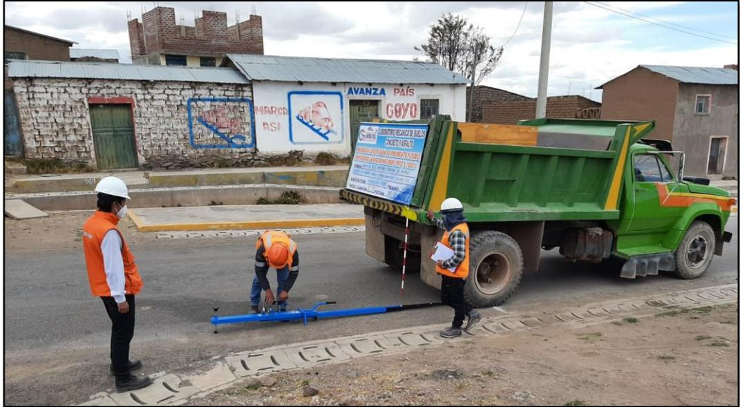
**Figura 25:** Ajuste perpendicular de la Viga Benkelman
