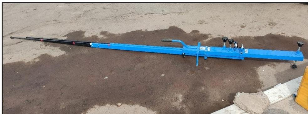
**Figura 13:** Viga Benkelman usada en campo
