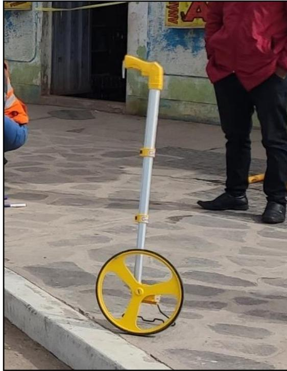
**Figura 17:** *Odómetro usado en campo*
