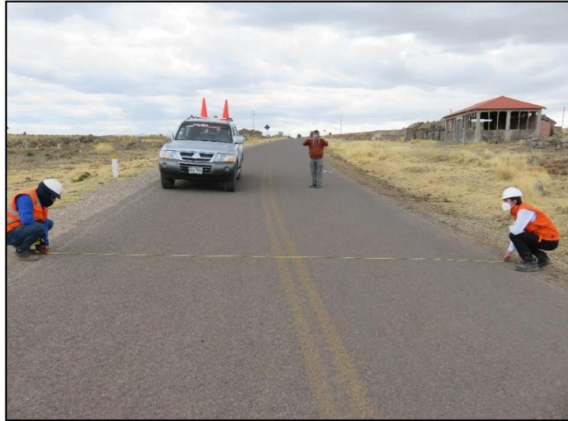
**Figura 21:** Medición del ancho de calzada
