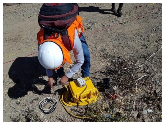
Instalación de Equipo Sísmico Fuente, Autor 2020
