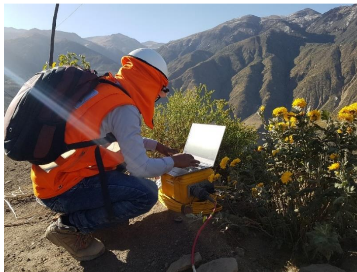
Nota. La figura muestra el registro de datos perteneciente al ensayo MASW 01.
