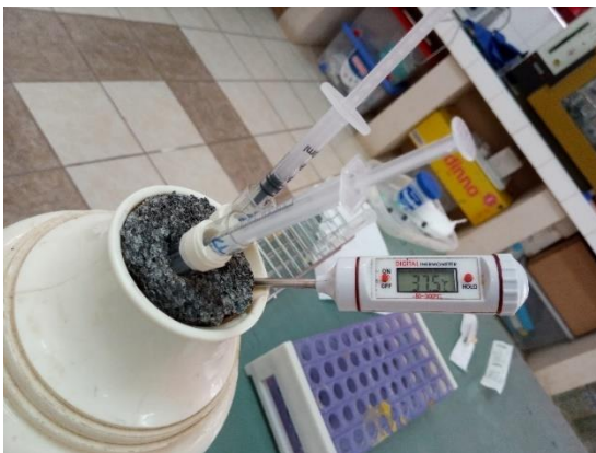
Figura N° B.6. Baño maría (37 °C), acondicionado en un termo sobre el cual están dos tubos de ensayo con dilutor y jeringas de colección
