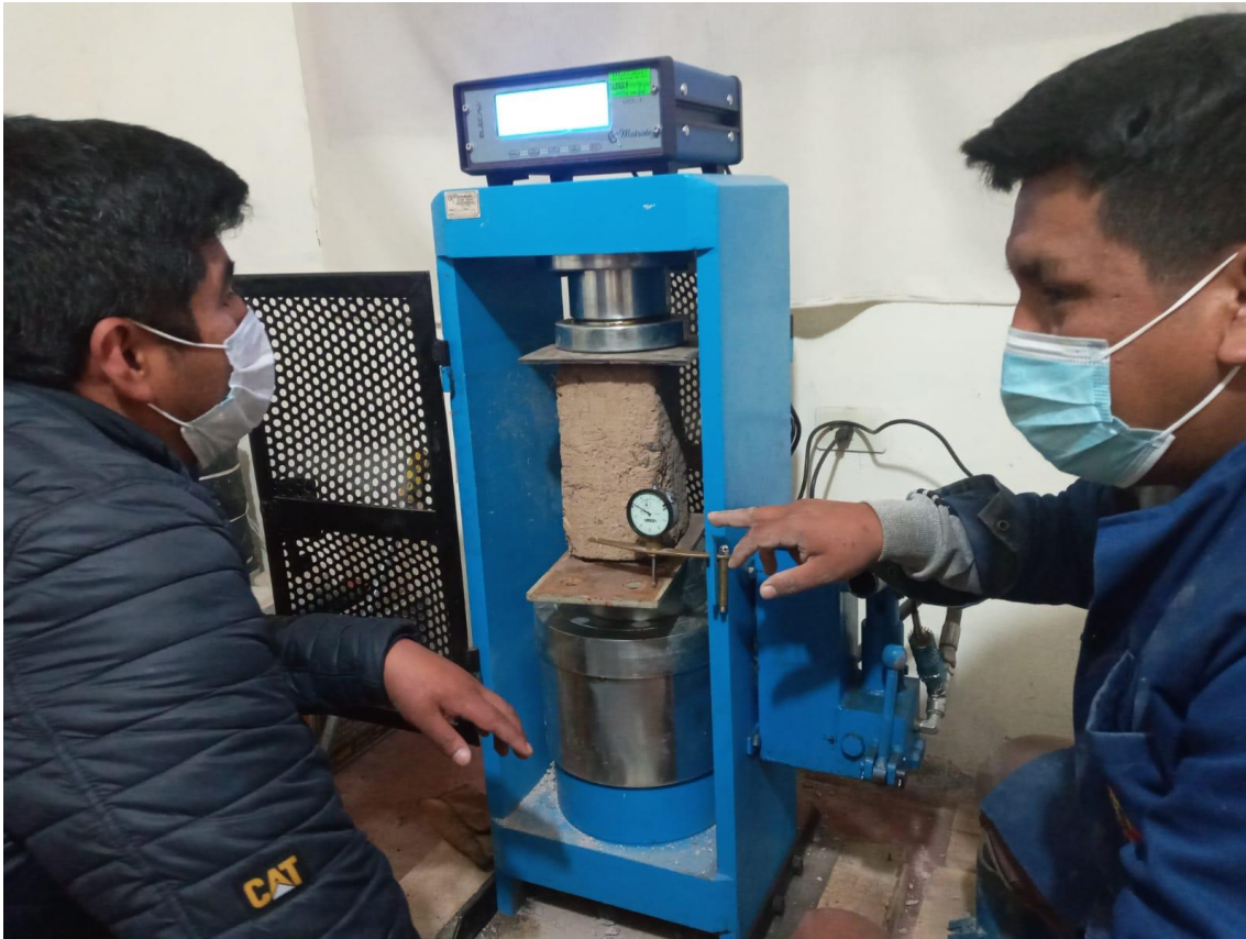
FIGURA N°09 (LABORATORIO DE SUELOS). Nota (Ensayo a compresión simple del adobe). Fuente (Toma de imagen del equipo de trabajo).
