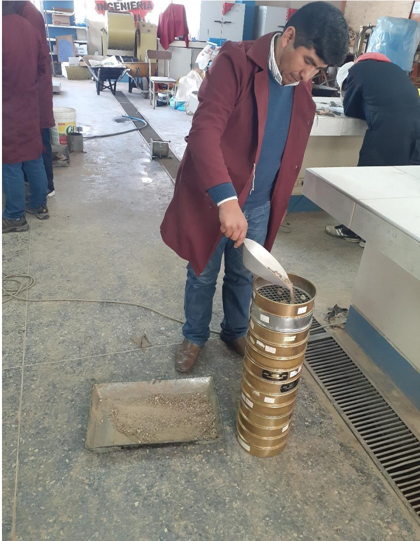
FIGURA N°07 (LABORATORIO DE SUELOS). Nota (Análisis Granulométrico). Fuente (Toma de imagen del equipo de trabajo).
