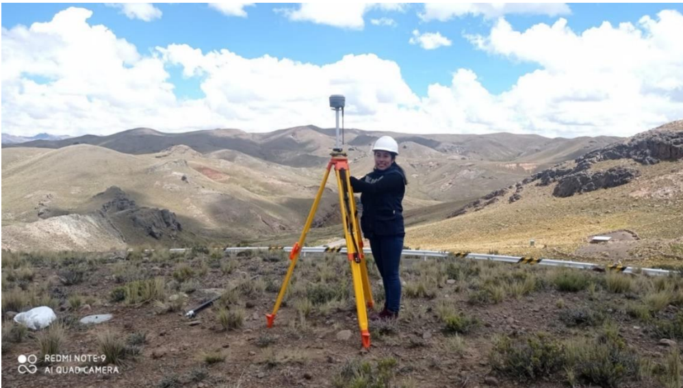
Foto N°2: instalación del equipo GPS diferencial
