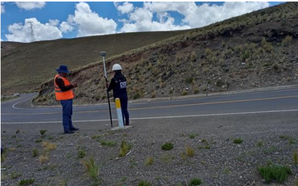
Foto N°4: levantamiento topográfico de la calzada
