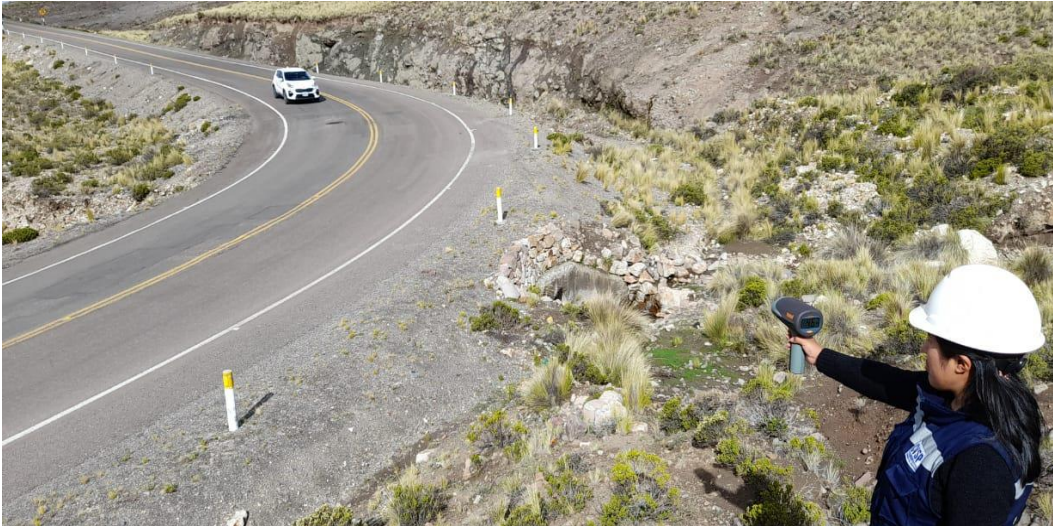
Foto N°7: Medición de velocidad en curva N°7
