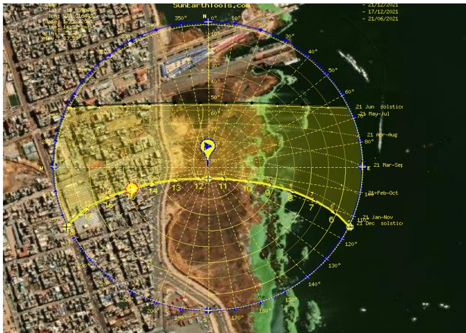
Figura N° 72: Geometría solar para la propuesta de diseño
