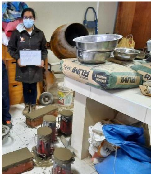
*Figura 6. Vaciado de concreto en moldes cilíndricos y prismáticos.*
