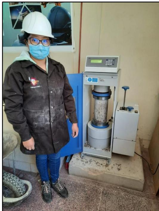
Ensayo de resistencia a la compresión  $f'_c=210 \text{ kg/cm}^2$
