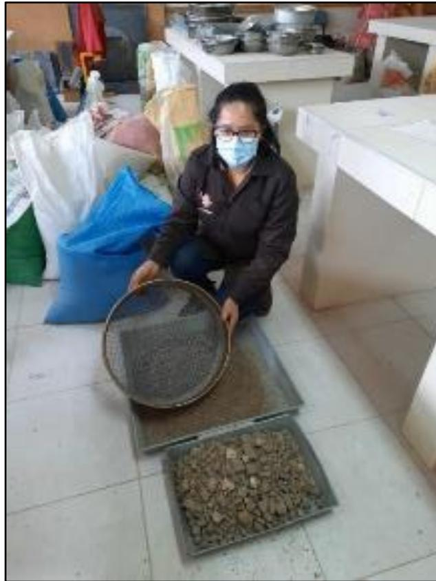
Separado del agregado grueso y fino mediante el tamiz N°4
