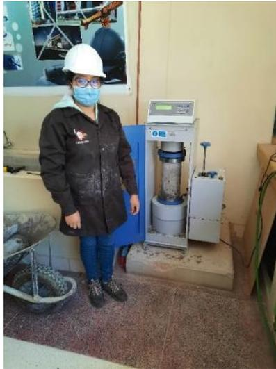
*Figura 10. Ensayo de resistencia a la compresión del concreto.*
