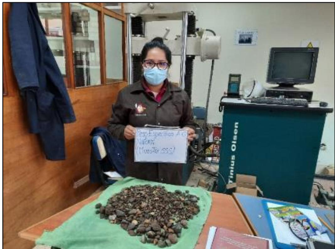
Peso específico del agregado grueso, muestra S.S.S.
