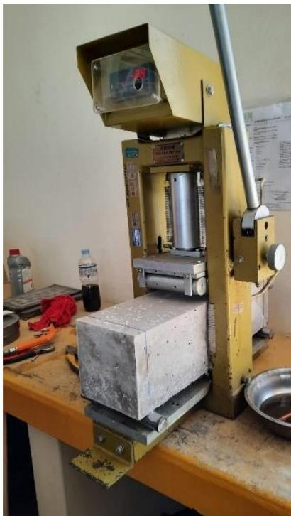
**Figura 13.** *Máquina de ensayo de resistencia a la compresión utilizado.*
