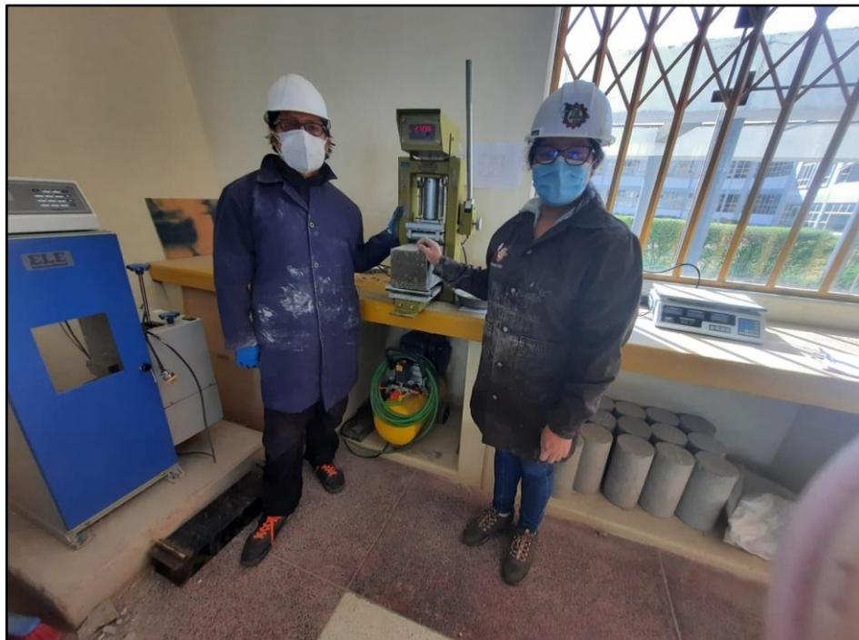
Colocación de la muestra en la máquina de ensayo a flexión del concreto
