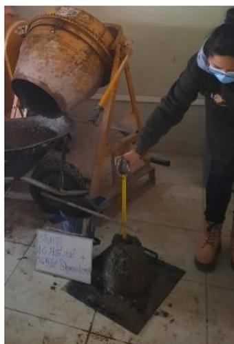
**Figura 9.** Ensayo de cono de Abrams.
