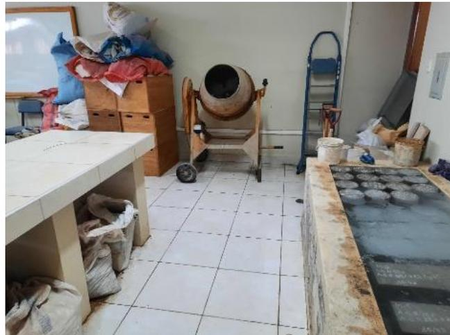
*Figura 7. Curado a temperatura ambiente de probetas cilíndricas y prismáticas.*
