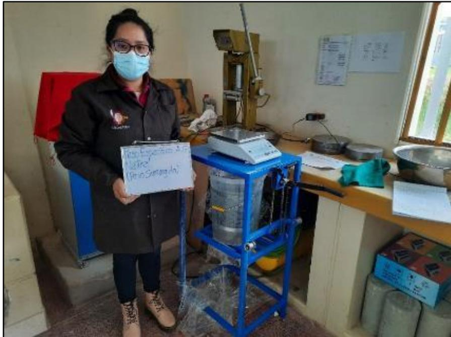
Peso específico del agregado grueso, peso sumergido de la muestra.
