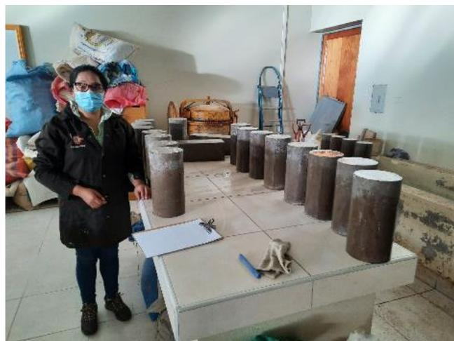
*Figura 8. Probetas extraídas de la poza de curado.*
