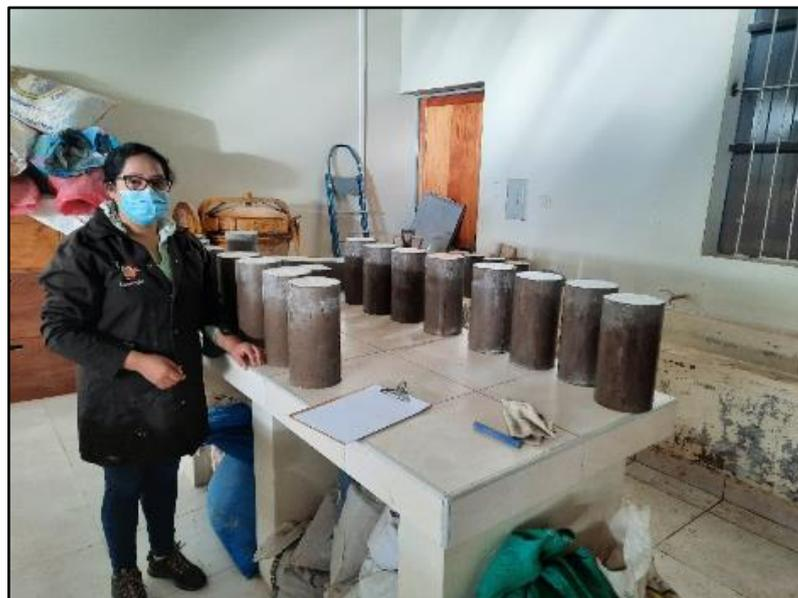
Testigos para el ensayo de resistencia a la compresión
