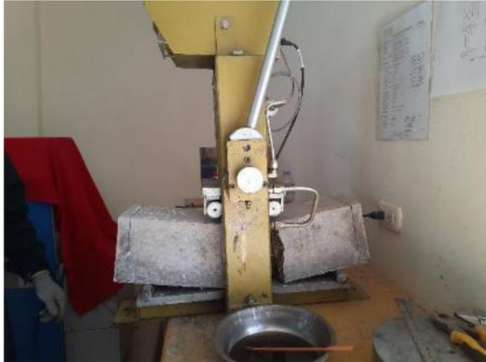
*Figura 15. Espécimen de concreto después de la falla o ruptura.*
