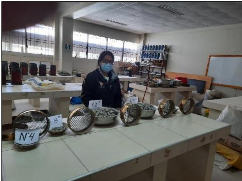
Análisis granulométrico del agregado grueso reciclado.
