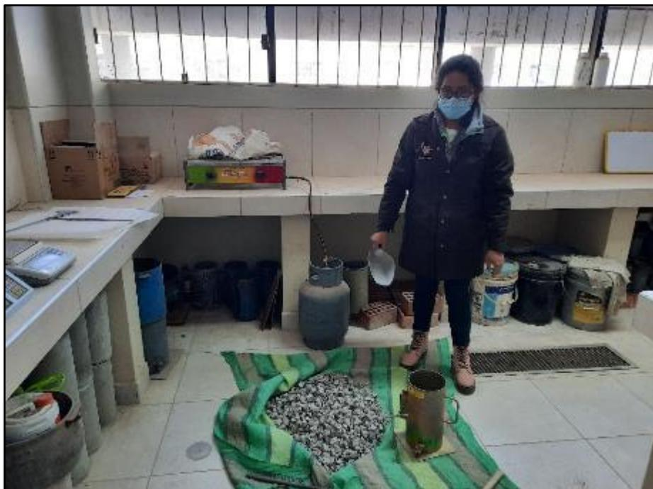
Peso unitario suelto y compactado del agregado grueso reciclado.
