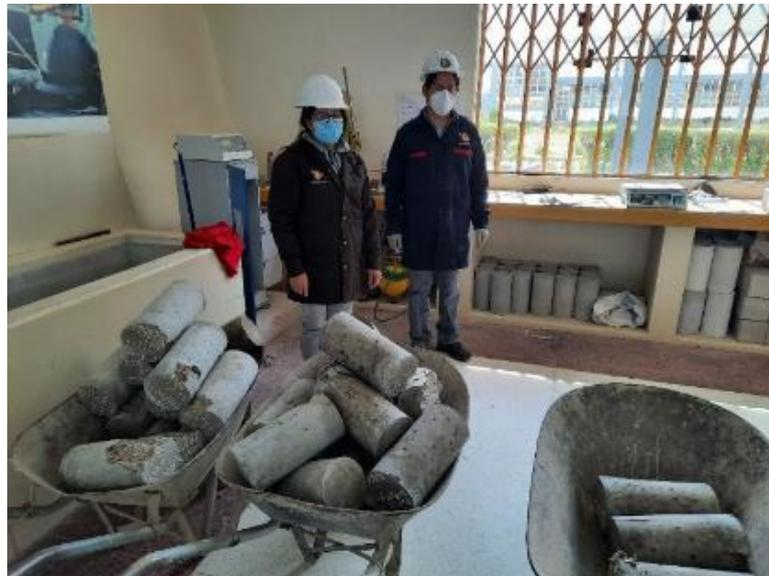
*Figura 11. Muestras cilíndricas después del ensayo de resistencia a la compresión.*
