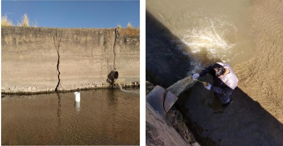
*Figura 50: Medición del caudal y temperatura del ARM*
