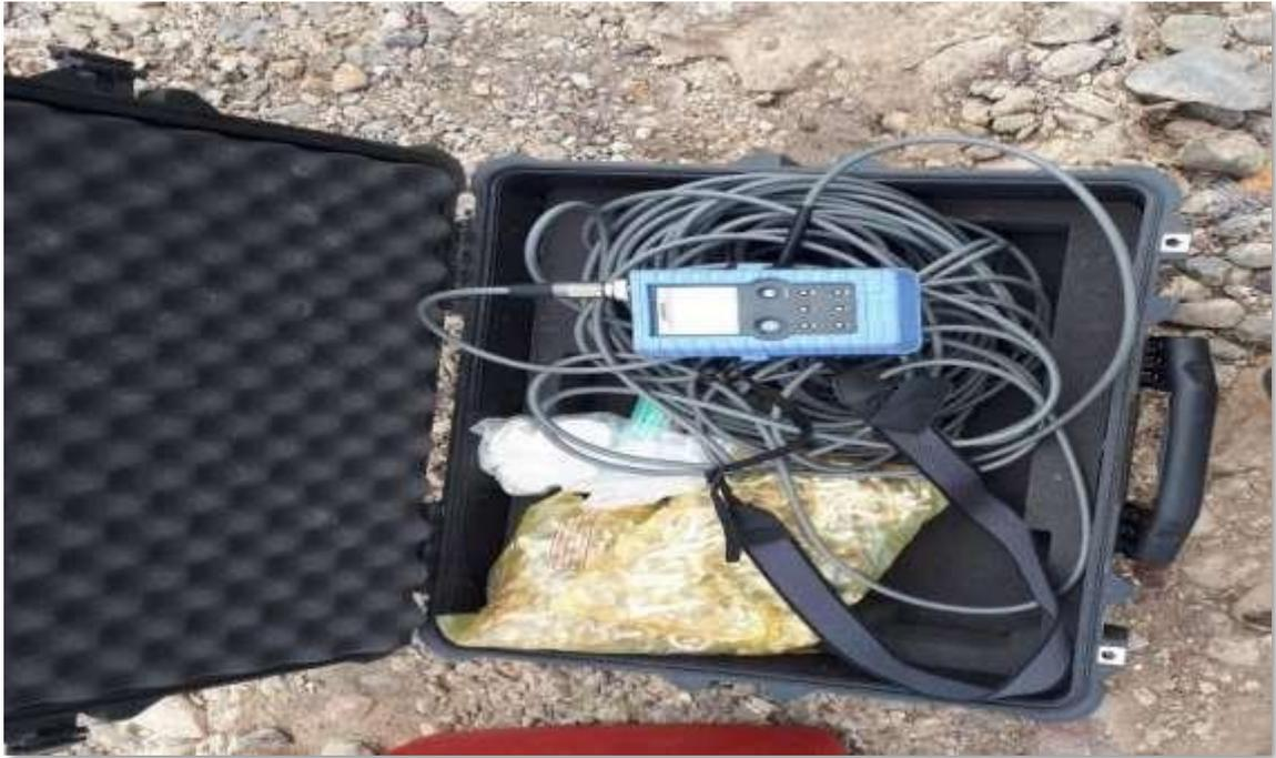
*Figura 10.* Medidor multiparamétrico de valores pH, CE, TDS, T°.
