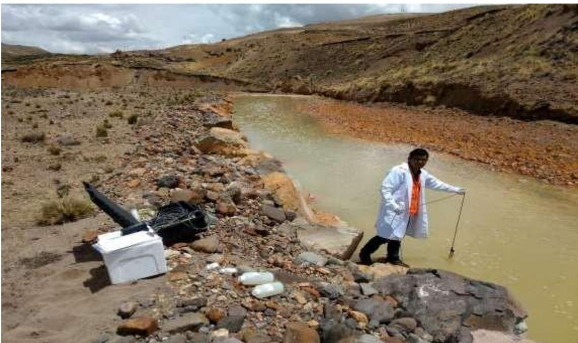
*Figura 9.* Punto de muestreo P-2, 250 m aguas abajo del puente peatonal, se observa elevada turbidez
