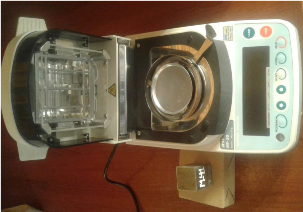
Figura 18: Secado de las muestras de suelo en “Termobalanza electrónica”
