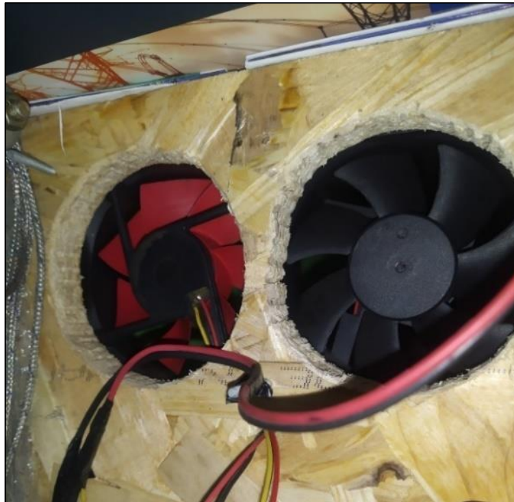
Figura 26: Vista interior del sistema de enfriamiento del sistema
