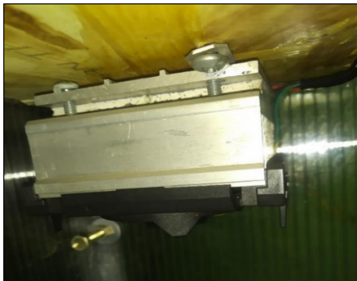
Figura 23: Sistema de calefacción del prototipo
