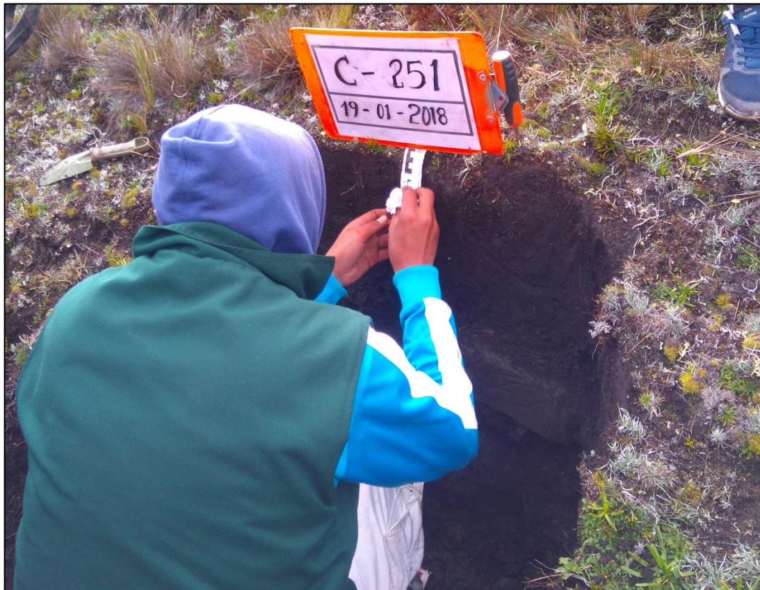
Figura 30. Limitación de horizontes de calicatas
