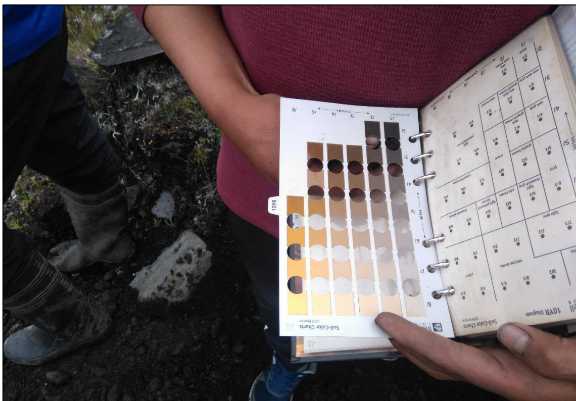
Figura 31. Lectura de calicatas, mediante la comparación con la hoja de colores de la Tabla Munsell (Sistema Munsell)
