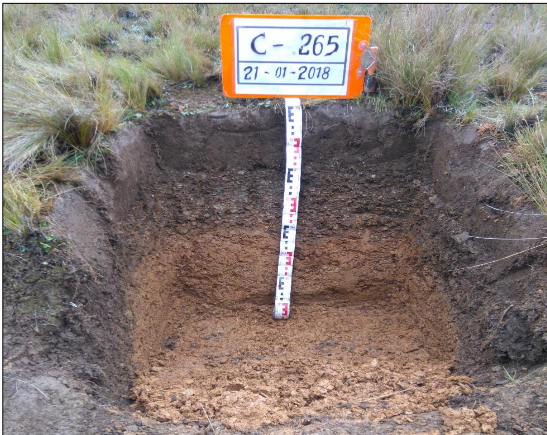
Figura 29. Identificación de horizontes o capas de las calicatas
