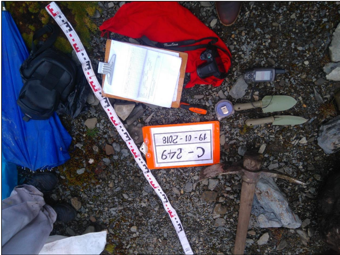
Figura 28. Materiales y equipos para las lecturas de calicatas
