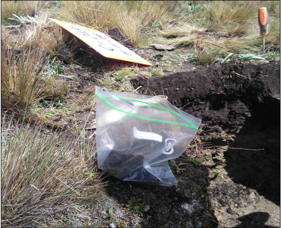
Figura 32. Extracción de muestras de suelo de calicatas por cada horizonte
