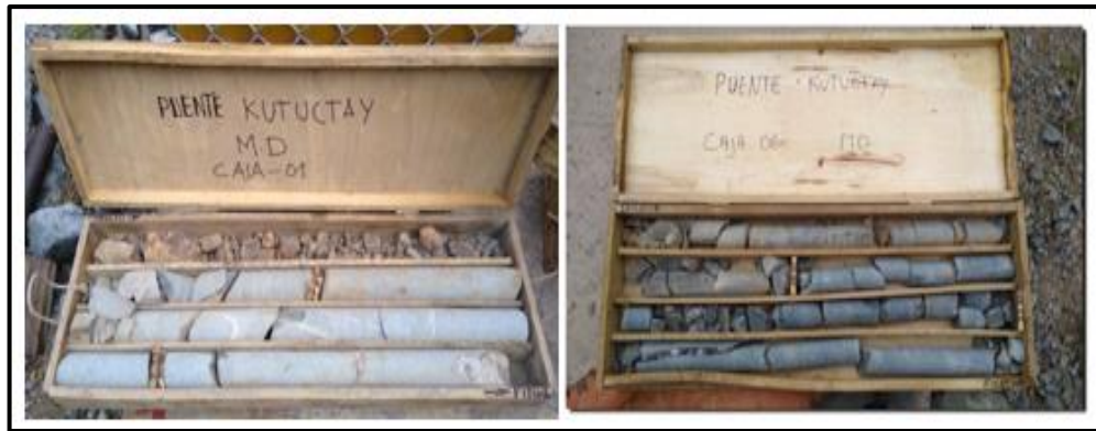
Figura 63. Almacenamiento de las muestras en porta testigos de la perforación P-01.
