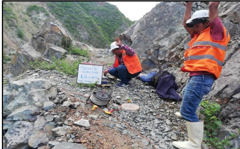
Figura 61. Obtención de datos sísmicos con golpes de Martillo de 20 Libras.
