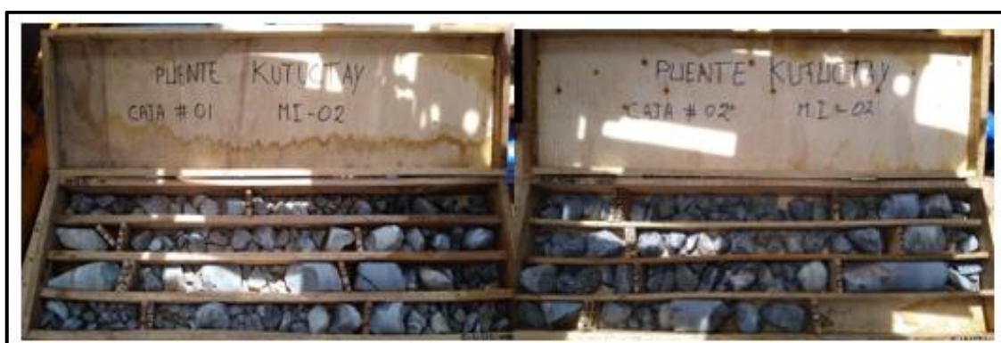
Figura 69. Almacenamiento de la Perforación P-03.
