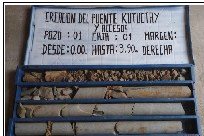
Figura 13. Profundidad de la masa rocosa en testigos. Fuente: Elaboración propia.
