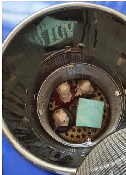
**Figura 10.** Autoclavado de material de vidrio y medios de cultivo.
