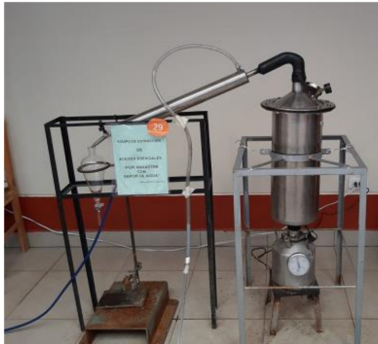
Figura 5. Equipo de extracción de aceites esenciales tipo Clevenger. Laboratorio de Operaciones y Procesos Unitarios FIQ-UNA-PUNO, Agosto 2021.
