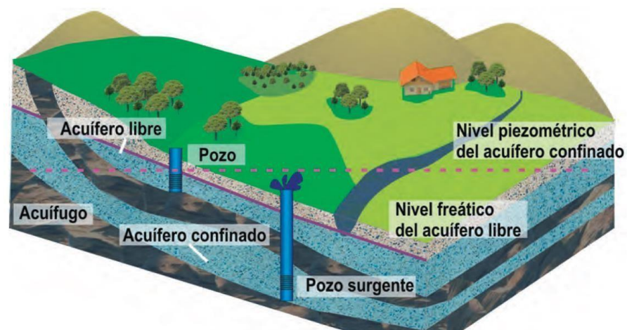
Figura 5. Pozo en un acuífero libre y confinado,Manual de Agua Subterránea, Collazo & Montaña , 2012
