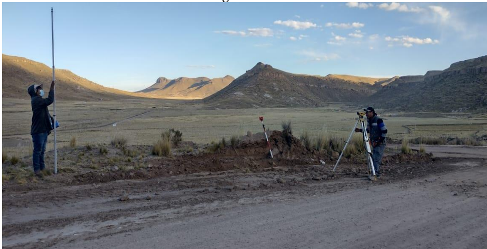
Figura A.6 Levantamiento con del Nivel de Ingeniero
