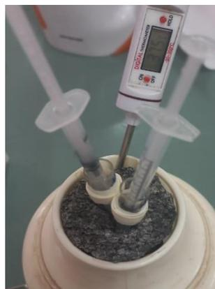
Figura 7. Baño de maría a 37°C, acondicionado en un termo donde se colocaron tubos de ensayo con dilutor y jeringas de colección.
