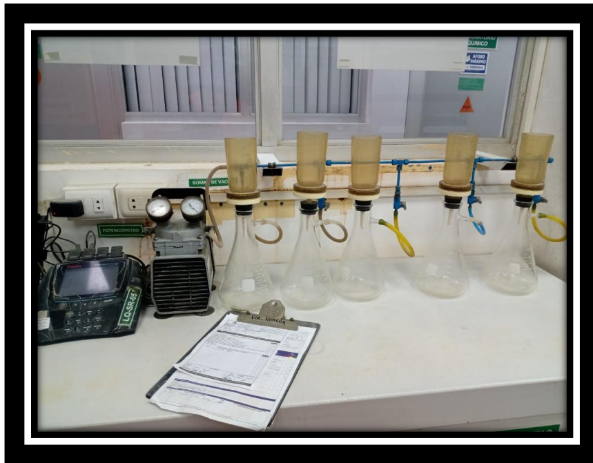
Multiparámetro y bombas centrífugas para el análisis de las aguas
