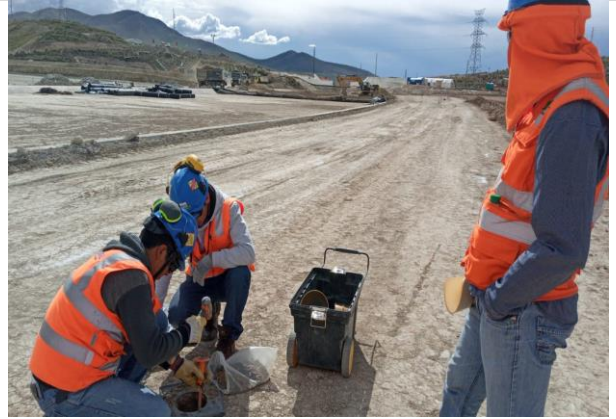
Foto 166. Prueba de densidad en fondo de canal.
