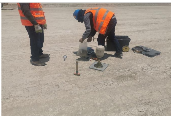
Foto 220. Ensayo de cono de arena en plataforma a nivel de la capa de arcilla.
