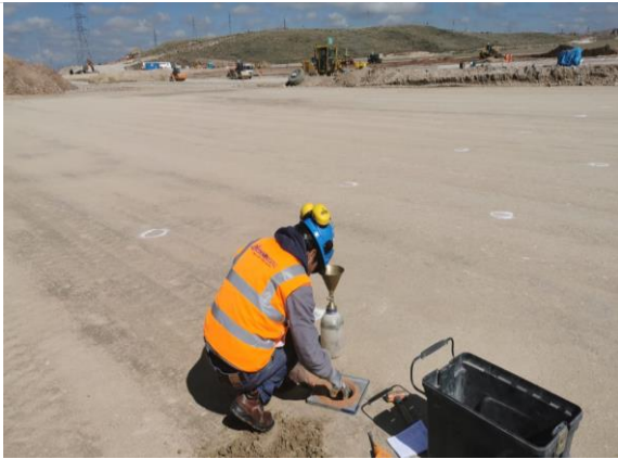
Foto 222. Ensayo de cono de arena en plataforma a nivel de la capa de arcilla.
