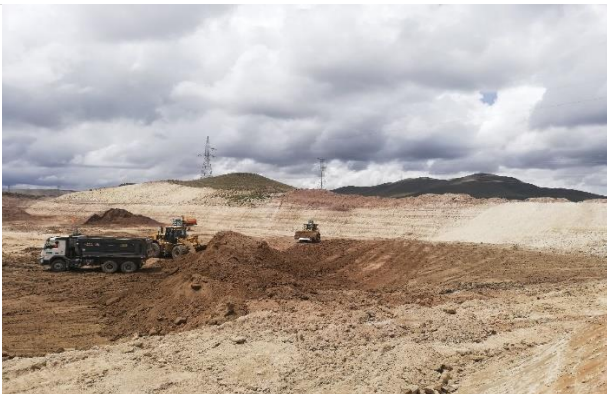
Foto 151. Carguío de arcilla en cantera.
