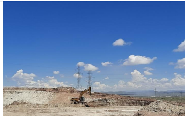
Foto 152. Carguío de arcilla en cantera.
