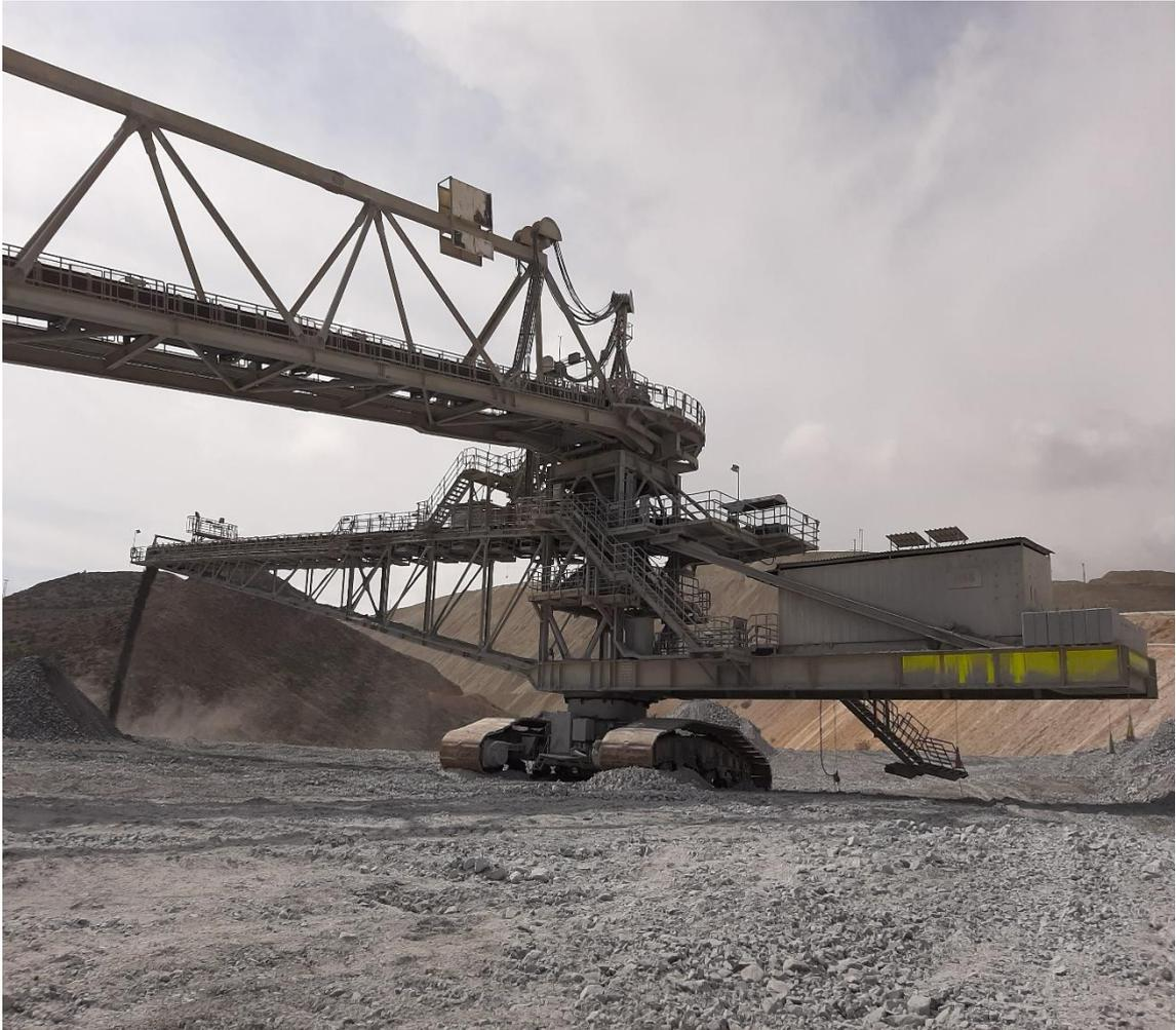
**Figura N° 44:** Fajas móviles sobre orugas Spreader.
