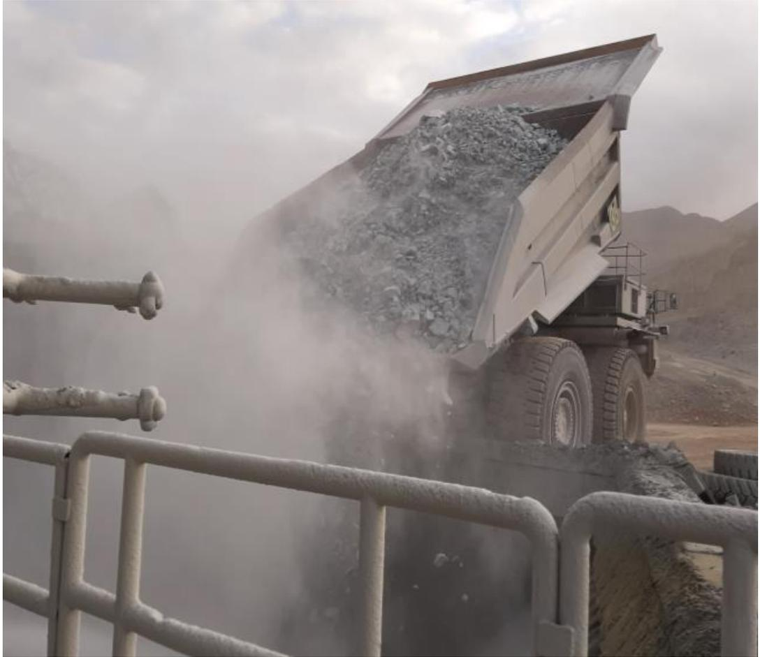
**Figura N° 38:** Tolva de descarga de chancadora primaria.
