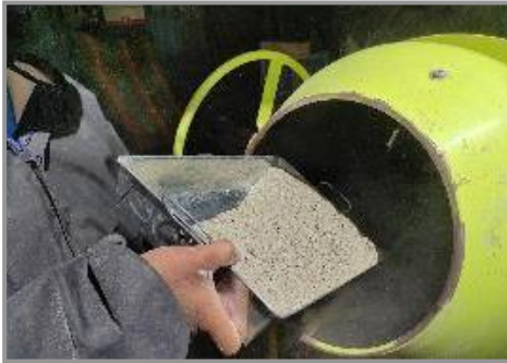
(c) Incorporación de Cemento portland 09/06/2021
