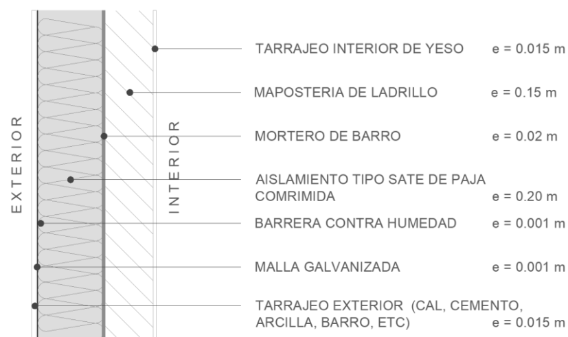
Figura 125. Composición y Dimensionamiento de la Envolvente Térmica - Sistema SATE de paja y barro.
