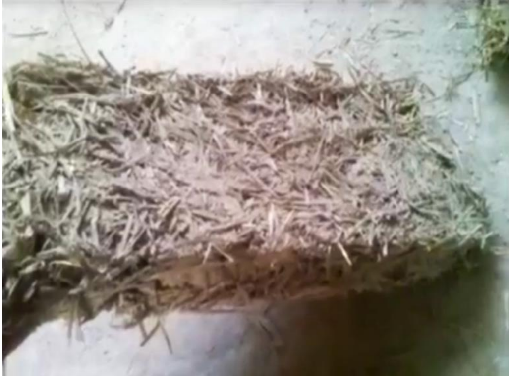
Figura 68. Fardo de paja comprimida de densidad media para aislamiento SATE de muros.
