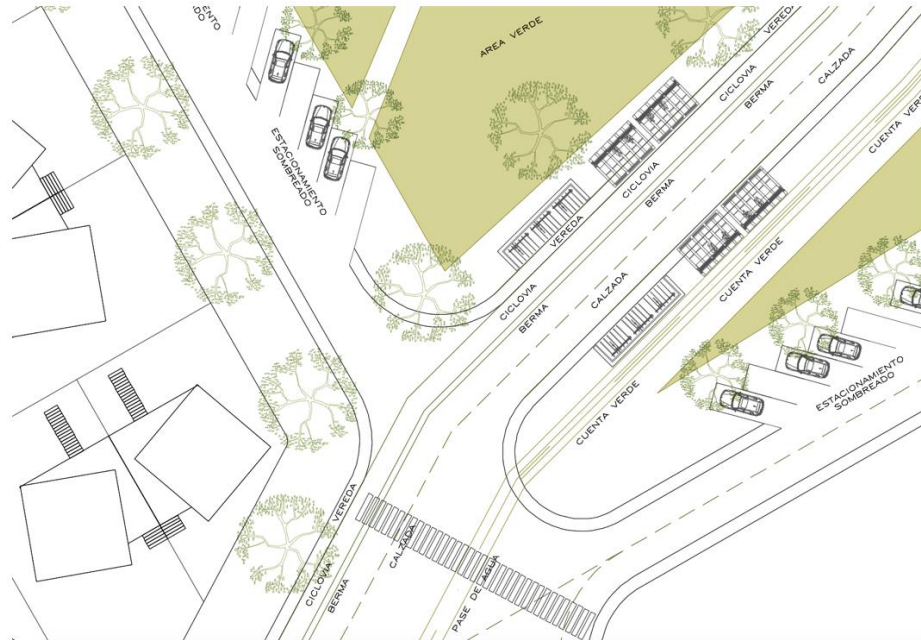
Figura 60. Equipamiento Urbano sustentable - Ciclovía, bermas de seguridad, estacionamientos sombreados, cunetas verdes e iluminación nocturna eficiente.
