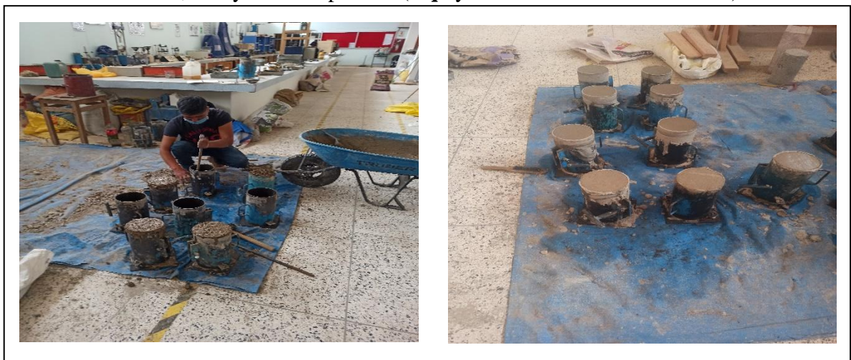
Foto N° 17, ensayo de compresión ( izq. y der. llenado de briqueteras con concreto mezclado)
