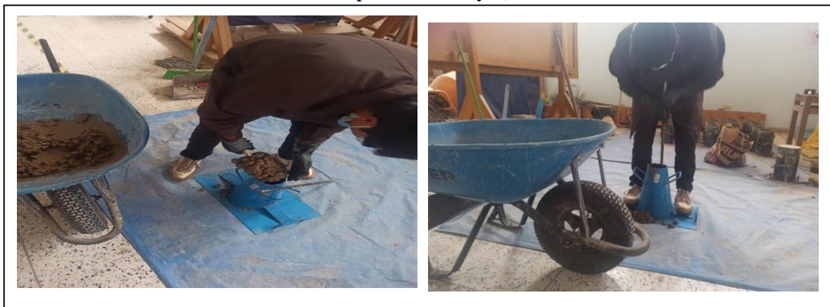
Foto N° 11, ensayos en concreto fresco ( izq. preparado y colocado del material a ensayar, der. proceso de Slum.)
