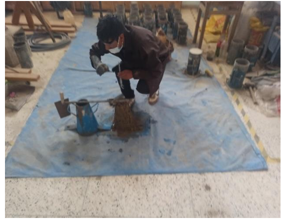
Foto N° 13, ensayos en concreto fresco ( izq. medida de slum, der. tesista realizando la medida del Slum)
