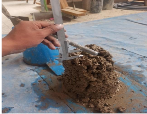
Foto N° 13, ensayos en concreto fresco ( izq. medida de slum, der. tesista realizando la medida del Slum)
