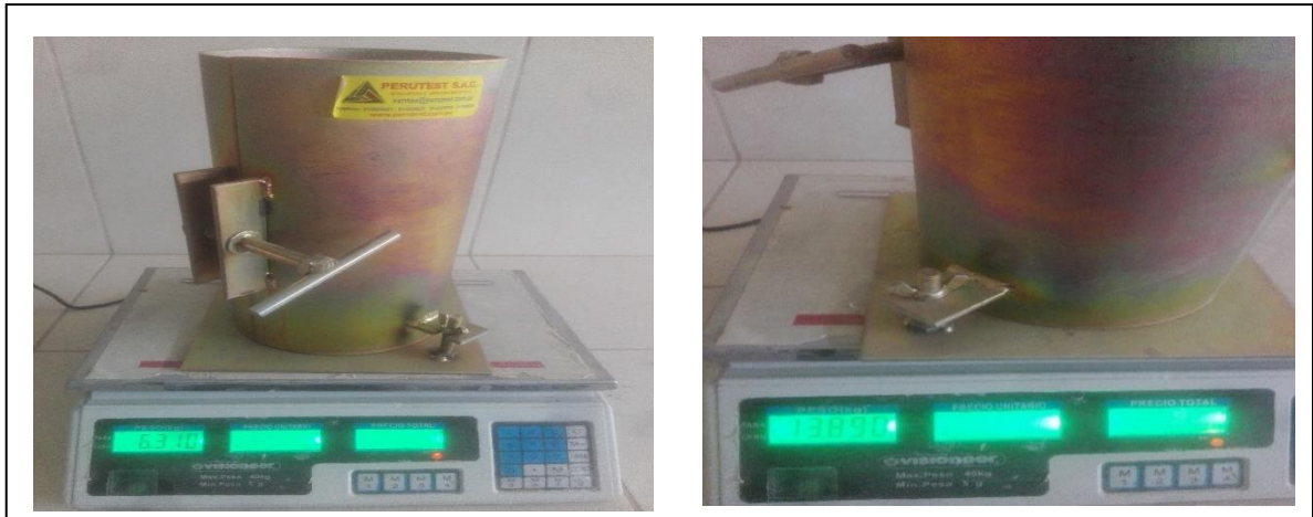
Foto N° 04, peso específico y absorción ( izq. briquetera vacía, der. briquetera con material de estudio)
