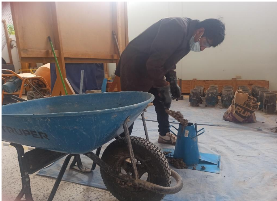
Figura N° 29: Ensayo de asentamiento, cono de Abrams
