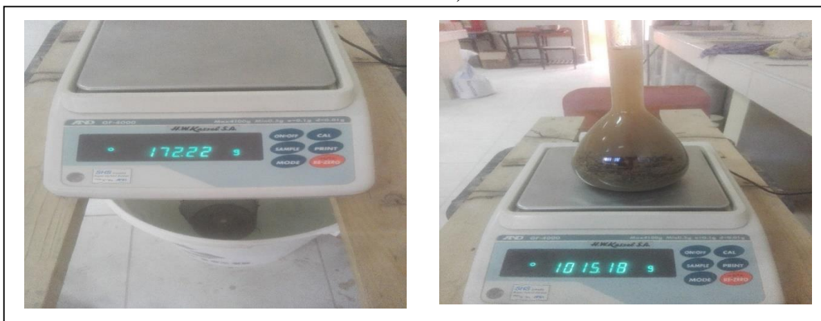
Foto N° 05, peso específico y absorción ( izq. canastilla sumergida sin material de estudio, der. peso del picnómetro + agua + peso de la arena superficialmente seca.)
