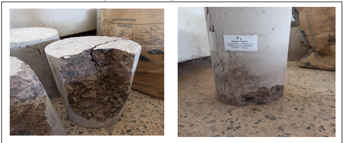
Foto N° 20, ensayo de compresión ( izq. briqueta “cn”, der. briqueta “CFPP- 4.6 kg/m 3 ”)
