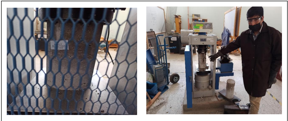
Foto N° 19, ensayo de compresión ( izq. rotura de briqueta, der. tesista presenciando la ruptura)
