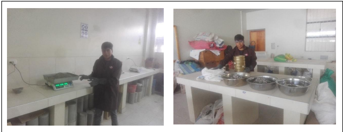
Foto N° 07, ( izq. peso del agregado fino, para el análisis granulométrico., der. proceso de tamizado del agregado grueso.)
