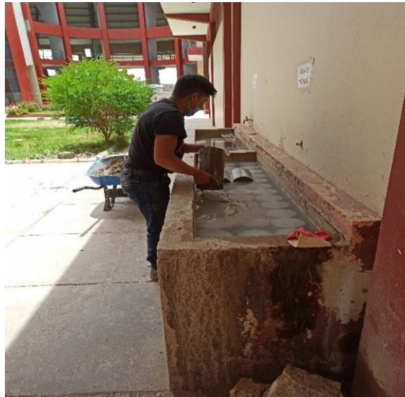
Figura N° 31: Proceso de curado de briquetas
