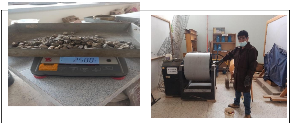
Foto N° 09, abrasión de los ángeles ( izq. obtención del material, der. máquina los Ángeles)
