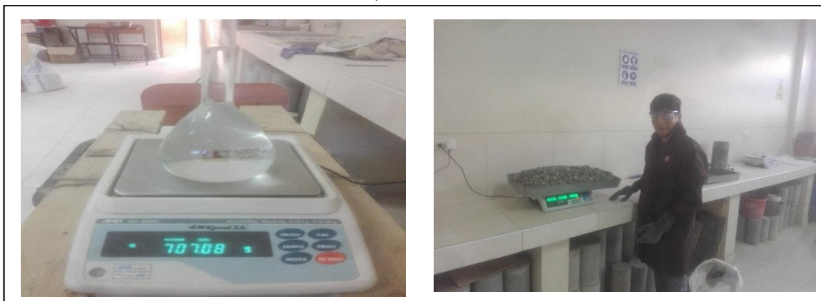
Foto N° 06, peso específico y absorción ( izq. peso del picnómetro + agua, der. peso de muestra para el ensayo de análisis granulométrico.)
