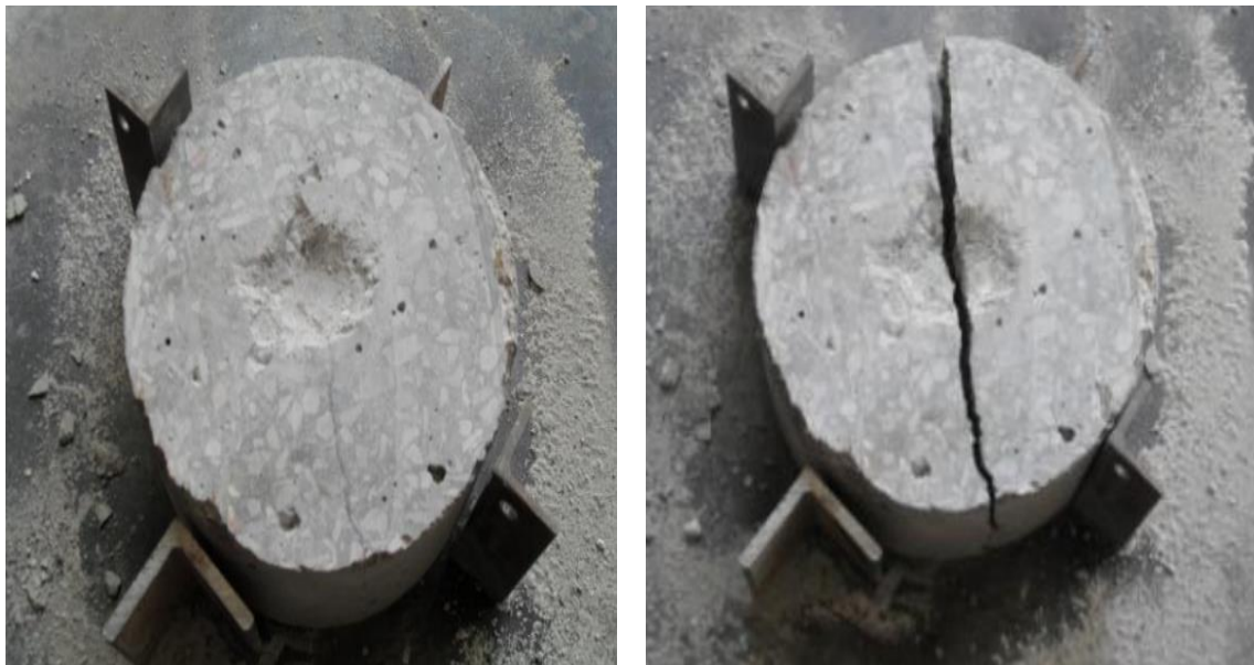
Figura N° 33: Testigo “CN” (izq. primera grieta, der. última grieta)
