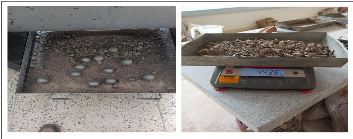
Foto N° 10, abrasión de los Ángeles ( izq. material luego del ensayo, der. peso del material después del ensayo.)
