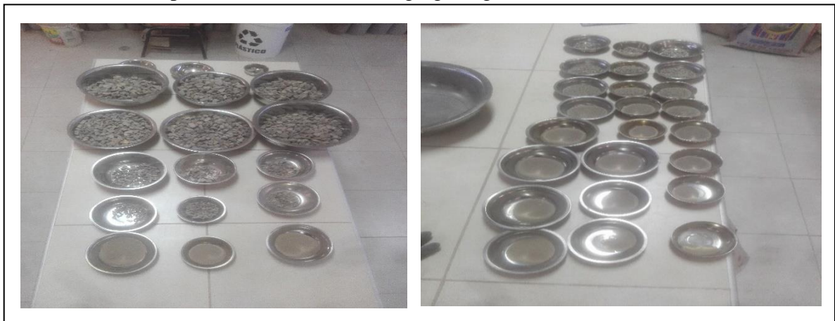
Foto N° 08, ( izq. y der. análisis granulométrico “3 ensayos”, del agregado grueso y fino.)
