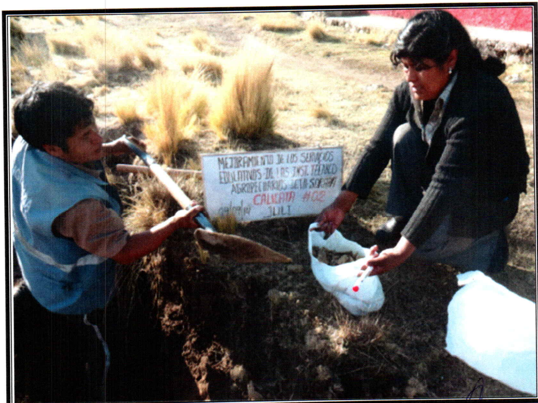
EN LA FOTO SE OBSERVA REALIZANDO LA CALICATA N° 02 EN EL I.E.T.A. SORAPA DISTRITO DE JULI PROVINCIA DE CHUCUITO JULI - PUNO.
