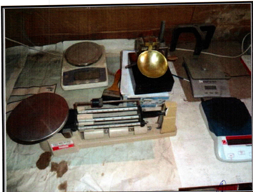
EN LA FOTO SE OBSERVA LOS EQUIPOS DE LABORATORIO PARA REALIZAR LOS ENSAYOS DE LIMITES DE CONSISTENCIA
