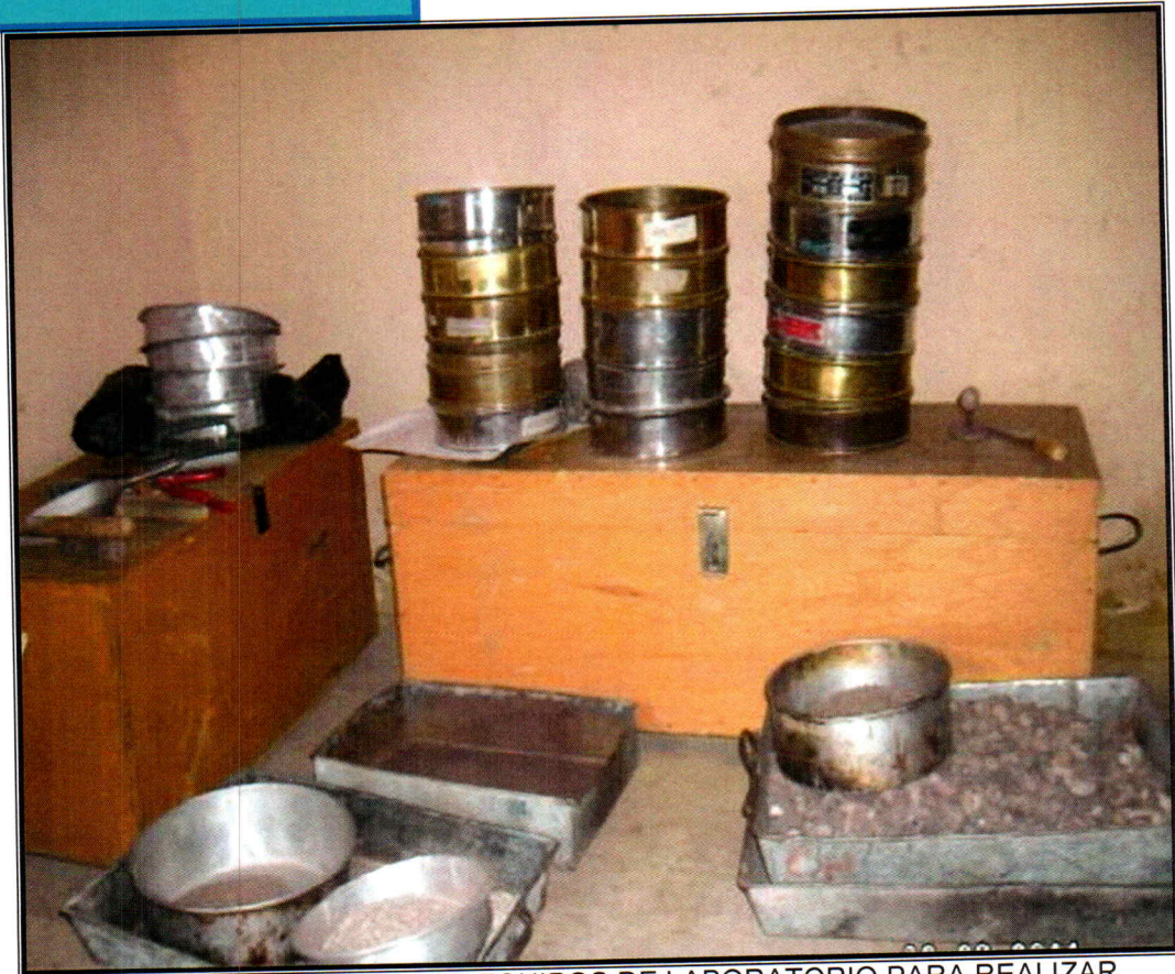
EN LA FOTO SE OBSERVA LOS EQUIPOS DE LABORATORIO PARA REALIZAR LOS ENSAYOS DE GRANULOMETRIA.
