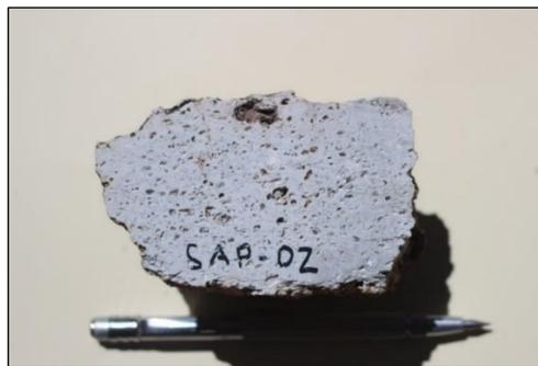
Figura 32. Muestra SAP-02, alterada y con alta intensidad y de distribución pervasiva.
