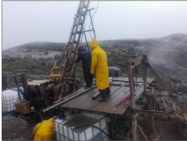
Figura 14. Instalación de plataforma de perforación.
