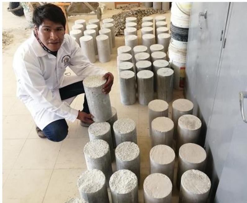
**Figura 13** *Especímenes para prueba de resistencia del concreto*
