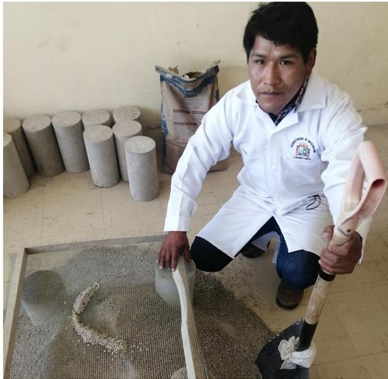
**Figura 10** Zarandeo por la malla N° 1/4" del agregado fino reciclado
