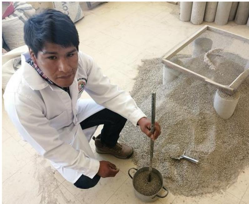
**Figura 11** Prueba del peso unitario seco compactado del AFR
