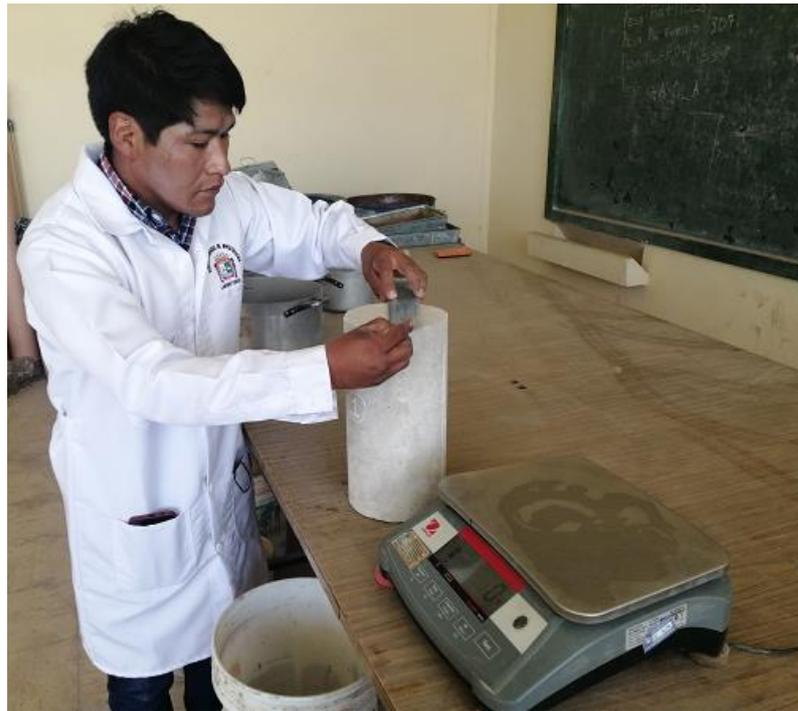
**Figura 14** *Determinación del mas dimensiones de los especímenes de concreto*
