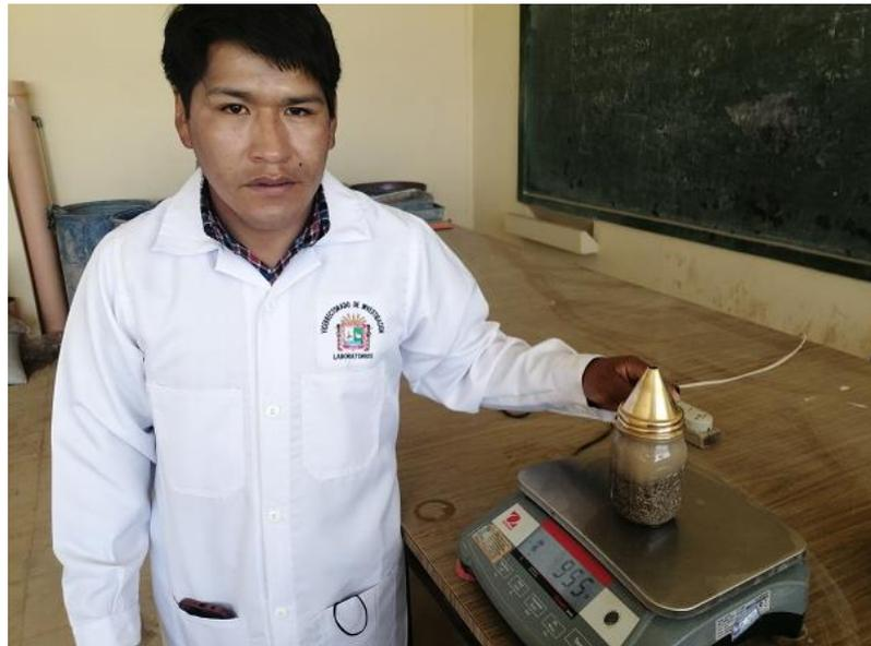
**Figura 12** *Determinación del Peso Específico del Agregado fino reciclado*
