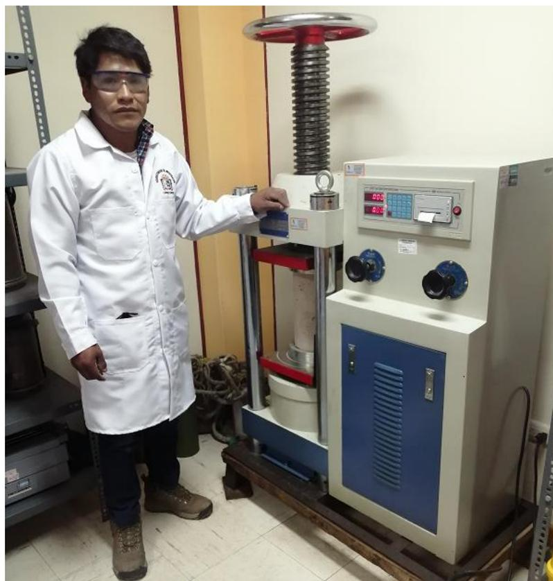
**Figura 15** *Prueba de resistencia a la compresión del concreto*
